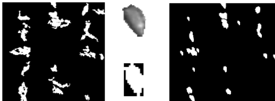
Figura 17. (esquerda) Imagem binarizada após a eliminação das regiões conectadas, (centro topo) média dos ovos utilizados para definir (centro abaixo) o elemento estruturante (direita) e imagem da esquerda depois da aplicação do operador de fechamento com esse elemento estruturante
