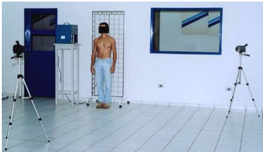
FIGURA 51 – ORGANIZAÇÃO DOS COMPONENTES DO MOCAP BIOFOTOGAMÉTRICO EM UMA COLETA DE IMAGENS REALIZADA NO LABORATÓRIO DIDÁTICO DE UMA INSTITUIÇÃO DE ENSINO SUPERIOR: CÂMERAS SOBRE TRIPÉS, ALINHADAS COM O PLANO DO SOLO PELO USO DE NÍVEL D'ÁGUA, EQÜIDISTANTES DO SUJEITO ANALISADO EM DISTÂNCIAS CONHECIDAS, MEDIDAS PELO USO DE TRENA, E SIMETRÓGRAFO AO FUNDO. FONTE: O AUTOR (2002)
