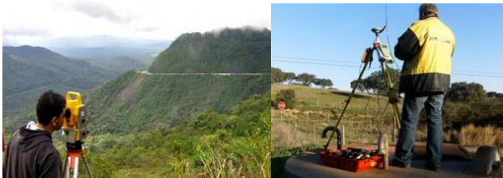
FIGURA 3 – ILUSTRAÇÕES REPRESENTATIVAS DA FOTOGRAMETRIA TERRESTRE OU FOTOGRAMETRIA DE CURTA DISTÂNCIA: AS ESTIMATIVAS DE MEDIDAS TOPOGRÁFICAS SÃO REALIZADAS A PARTIR DO POSICIONAMENTO DAS CÂMERAS E OUTROS EQUIPAMENTOS AUXILIARES NO SOLO. FONTES: [FIGURA À ESQUERDA] VIACARTA CARTOGRAFIA E AGRIMENSURA WEBSITE (ACESSO EM 29/10/2008). [FIGURA À DIREITA] UNIREFERÊNCIA TOPOGRAFIA WEBSITE (ACESSO EM 29/10/2008)
