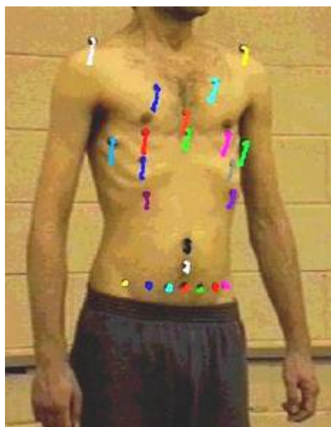
FIGURA 33 – ESTUDO EM CINEMÁTICA RESPIRATÓRIA UTILIZANDO O SISTEMA DVIDEOW: EXEMPLO DE RASTREAMENTO DE MARCADORES DE SUPERFÍCIE DURANTE MOVIMENTOS RESPIRATÓRIOS REGISTRADOS POR UMA DAS CÂMERAS. FONTE: LIB. LABORATÓRIO PARA INSTRUMENTAÇÃO EM BIOMECÂNICA - WEBSITE (ACESSO EM 17/07/2008)
