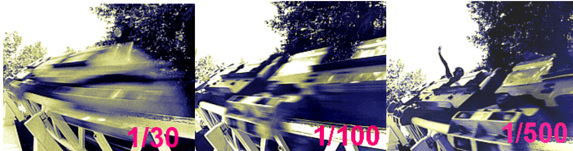
FIGURA 16 – IMAGENS ADQUIRIDAS POR CÂMERAS COM DIFERENTES VELOCIDADES DE ABERTURA DO OBTURADOR. NA VELOCIDADE 1/30 POR SEGUNDO, O EFEITO ESTROBOSCÓPICO É INTENSO, E APARENTA UM ARRASTO NA IMAGEM, IMPEDINDO A PERCEPÇÃO DA CENA. ESTA É REVELADA PELO USO DE UMA CÂMERA CUJA VELOCIDADE DE ABERTURA DO OBTURADOR É DE 1/500 POR SEGUNDO. FONTE: WHITTAKER; BARREIROS (ACESSO EM: 16/08/2008)
