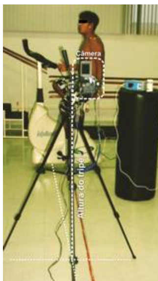
FIGURA 35 – ILUSTRAÇÃO DO POSICIONAMENTO DA CÂMERA PARA AQUISIÇÃO DE IMAGENS LATERAIS DOS MOVIMENTOS RESPIRATÓRIOS DA PT. FONTE: COTERLI (2005)
