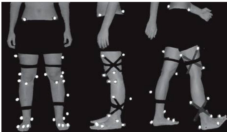
FIGURA 76 – MARCADORES DE SUPERFÍCIE ESFÉRICOS, RETRO-REFLEXIVOS, ORGANIZADOS EM PLANOS TRIANGULARES E UTILIZADOS PARA ESTUDOS DA MARCHA HUMANA. FONTE: ARAÚJO; ANDRADE; BARROS (2006)
