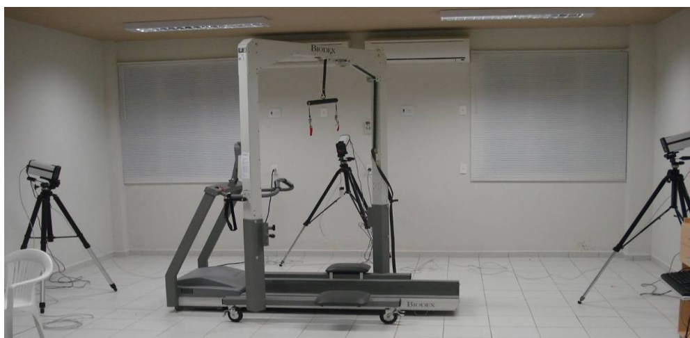
Figura 2: Posicionamento do sistema de análise do movimento e do Sistema Gait Trainer.
