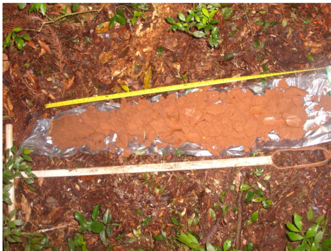
Figura 8 – Perfil do solo obtido por meio de tradagem na FLONA de São Francisco de Paula, RS. 2008
