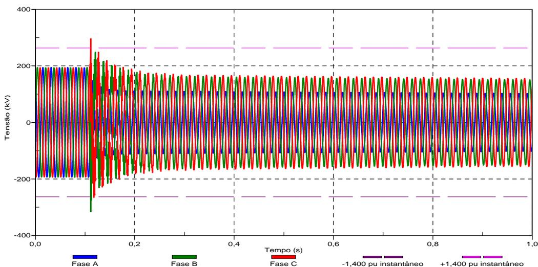
Figura 4.3 – Tensões no barramento 230 kV da SE Itapebi. Energização em vazio e sob falta da LT 230 kV Itapebi – Eunápolis (04N1), a partir da SE Itapebi (Referências:  $\pm 1,400$  pu, valor instantâneo).
