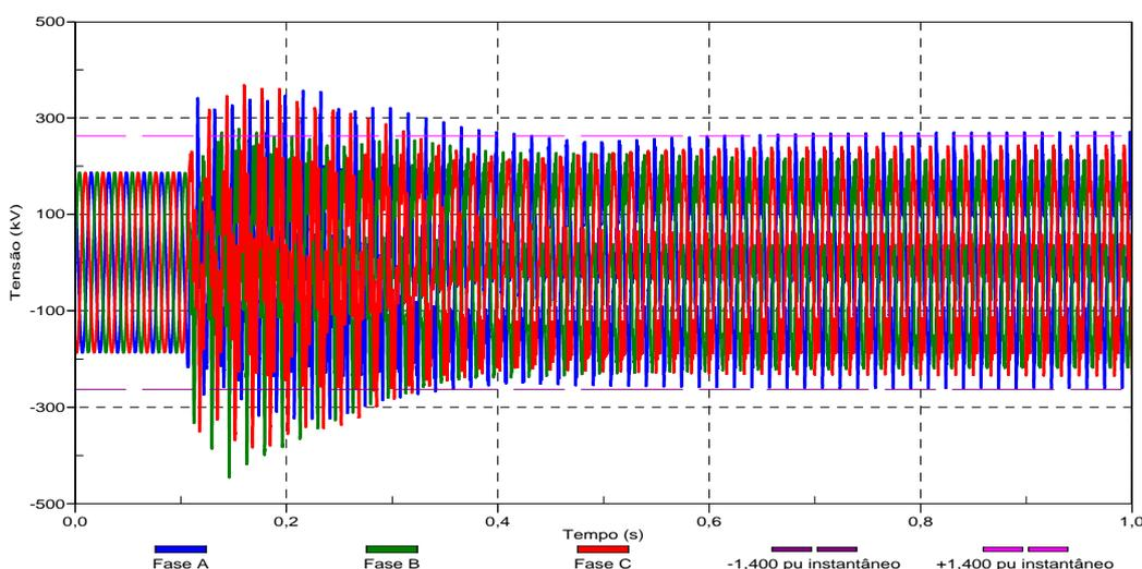
Figura 4.10 – Tensões no barramento 230 kV da SE Funil. Energização em vazio do primeiro transformador 230/138 kV, 100 MVA (04T1), da SE Funil. Tensão pré-manobra 1,000 pu (Referências:  $\pm 1,400$  pu, valor instantâneo).
