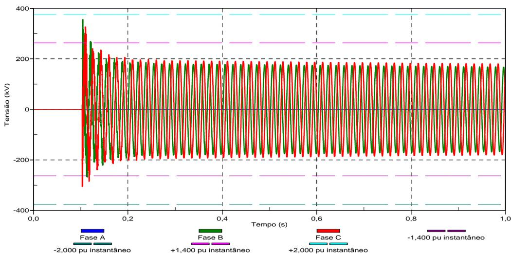
Figura 4.4 – Tensões no terminal aberto em Eunápolis. Energização em vazio e sob falta da LT 230 kV Itapebi – Eunápolis (04N1), a partir da SE Itapebi (Referências:  $\pm 2,000$  pu e  $\pm 1,400$  pu, valor instantâneo).
