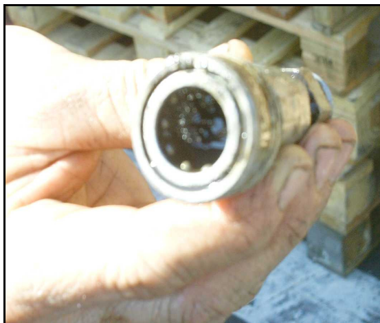
Figura 24 – Engate com contaminantes sólidos (antes da melhoria). Fonte: Empresa estudada.
