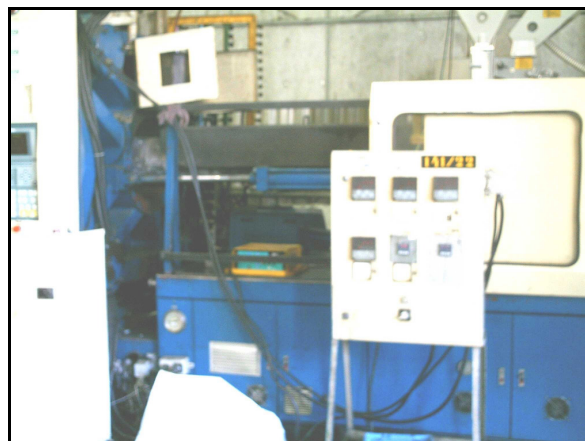
Figura 29 – Painel de controle de temperatura de câmara-quente (antes melhoria). Fonte: Empresa estudada.
