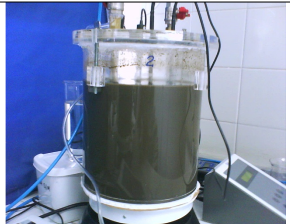
Figura 16. Detalhe da homogeneização e saída de gases imersa em água atrás do reator
