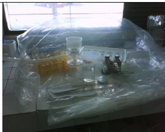
Figura 17. Atmos Bag ou saco de luvas com atmosfera de N_2(g) .
