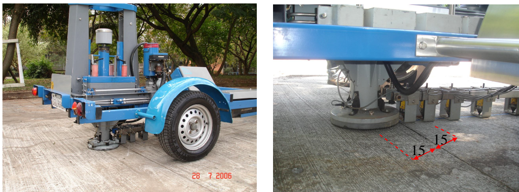
Figura 3.12 Posição do prato na junta da placa de concreto.
