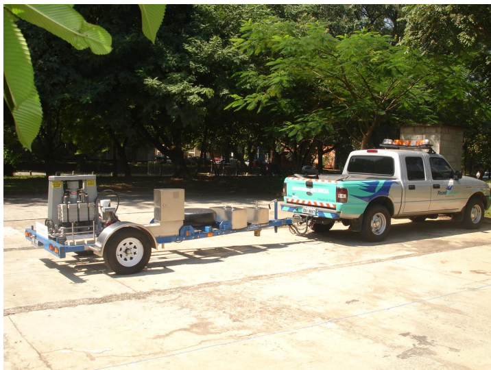
Figura 3.8 FWD na pista experimental da USP.
