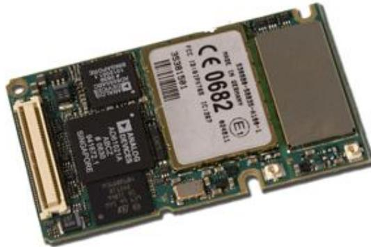
Figura 29 – Módulo XT65 para implementação do controle via GPRS.
