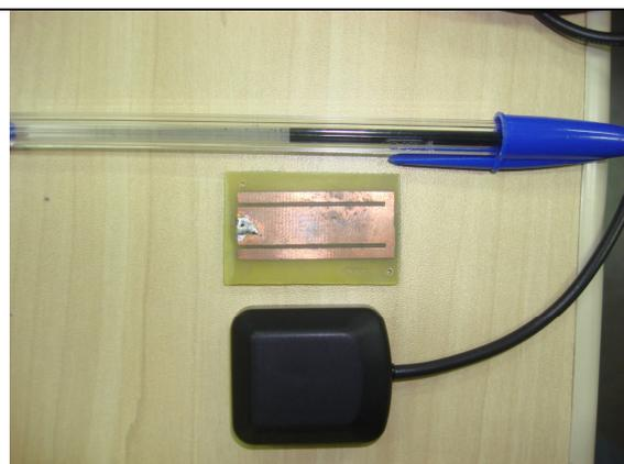
**Figura 59 - Antenas GSM (superior) e GPS (Inferior)**
