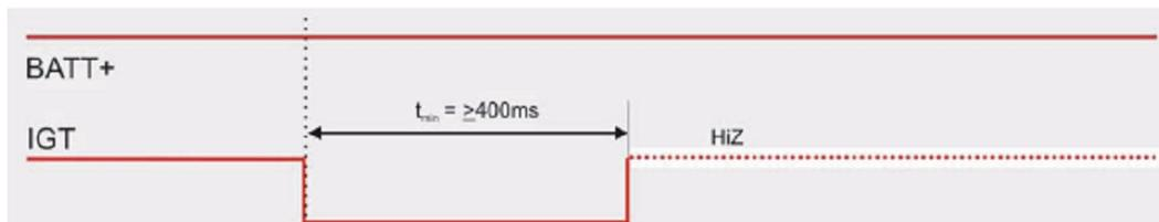
Figura 30 - Onda de representação do acionamento do XT65 [35]
