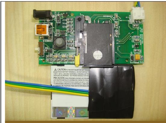
**Figura 60 - Placa final + bateria do localizador da UFSCar**
