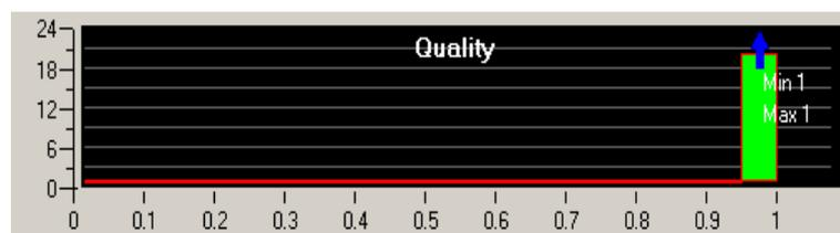
**Figura 4.7. Histograma de qualidade da malha com 44.898 elementos entre 0.95 e 1 de qualidade global.**
