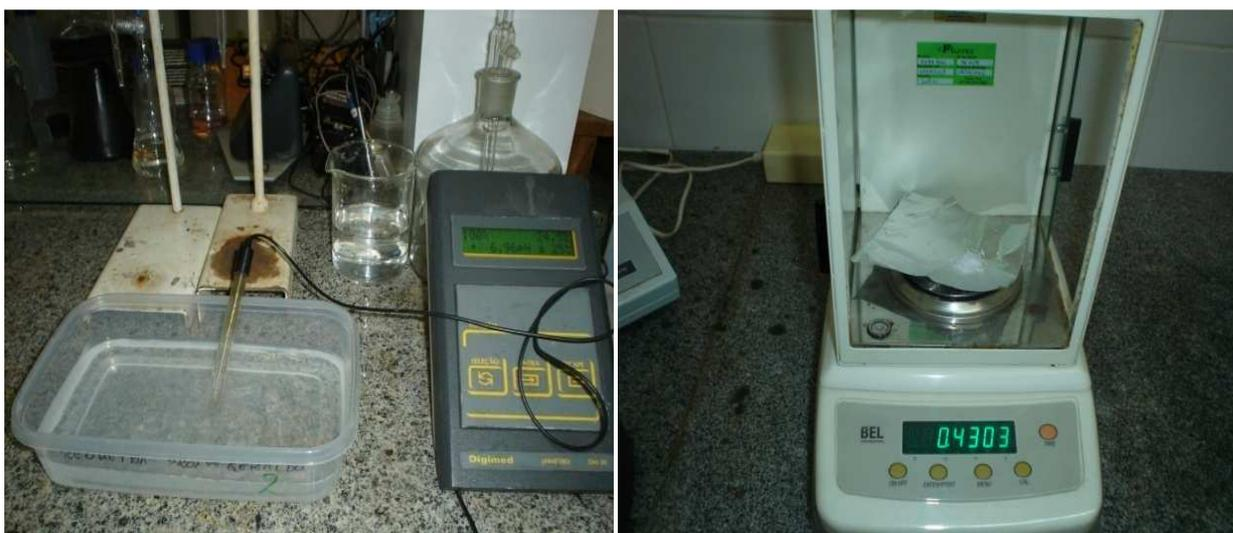
**Figura 5.4. pHmetro e Balança utilizados na preparação do gel Carbopol 940 respectivamente.**
