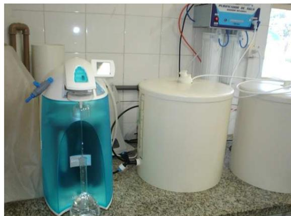
**Figura 5.3. Aparelhagem Millipore. (a)Modelo Simplicity Milli-Q; (b)Milli-Q ligado a um sistema deionizador por osmose reversa.**
