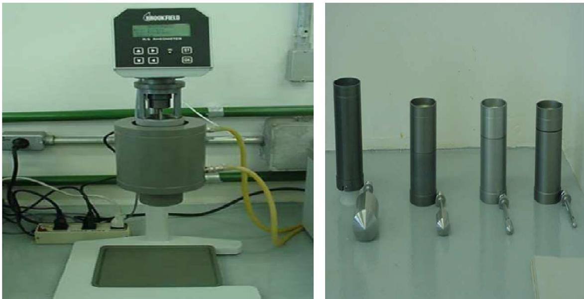
**Figura 5.1.** Aparelhagem utilizada para os ensaios de reometria, reômetro e spindles respectivamente.
