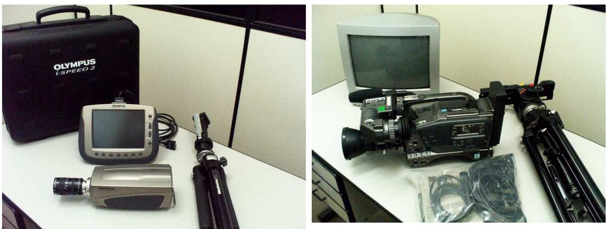
**Figura 5.5. Equipamentos de filmagem, câmera ultra-rápida i-Speed2-Olympus e JVC (GY DV 500) respectivamente.**
