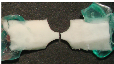
Figura 10 – Espécime após ensaio de tração
