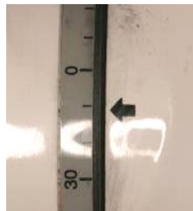
Figura 13 - Marca no goniômetro para o ângulo vertical de -10 graus.
