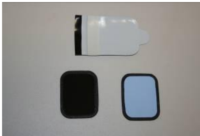
Figura 8 - Placas de fósforo foto estimulável e invólucro opaco a luz clara e impermeável (Digora® DFW).
