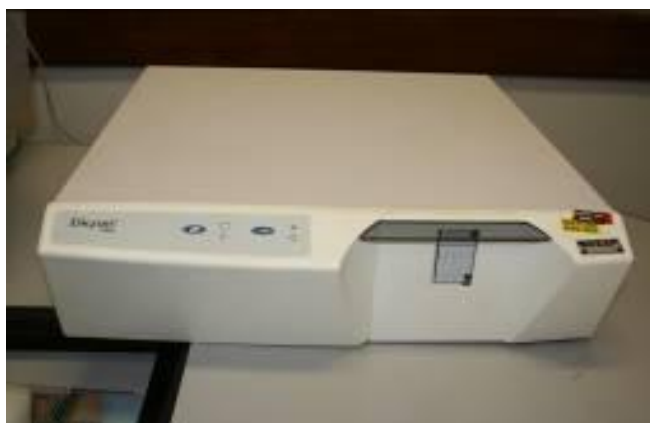
Figura 14 - Leitor a laser de placa de fósforo fotoativado Digora® (Soredex).
