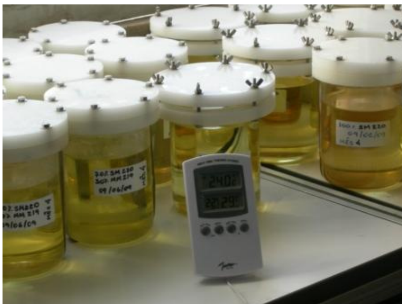
Figura 4.10. Armazenamento de Biodiesel soja/mamona e blendas
