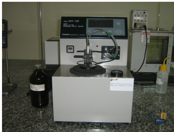
Figura 4.12. Equipamento Ponto de Entupimento de Filtro a Frio
