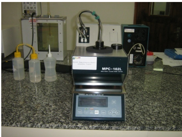
Figura 4.13. Equipamento usado para obtenção dos valores de Ponto de Névoa e Ponto de Fluidez.
