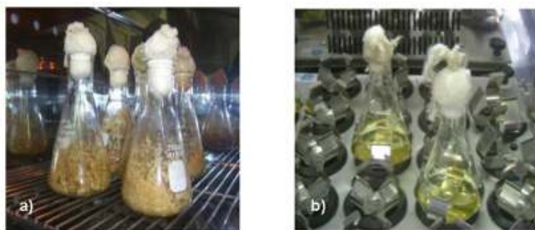
Figura 8. Formas de produção de Lipases: a) Fermentação em Estado Sólido e b) Fermentação Submersa.
