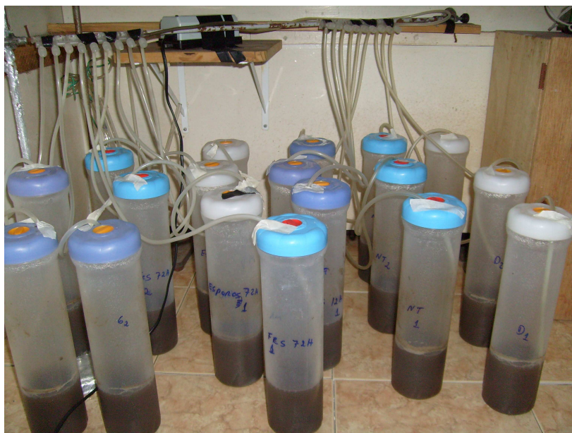
FIGURA 9 - REATORES UTILIZADOS PARA O TESTE DE BIODEGRADABILIDADE AERÓBIA
