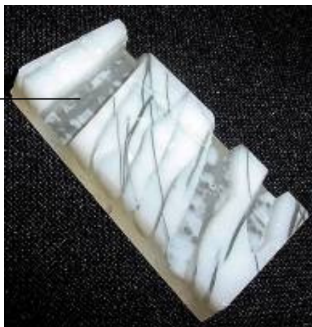
Figura 36. Resultado do ensaio número cinco, mostrando o baixo relevo resultante da usinagem.
