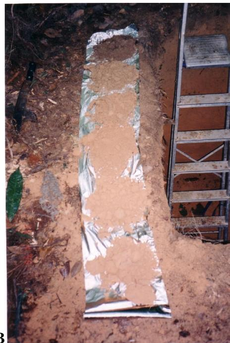
Figura 3. Identificação dos horizontes pedológicos (A=Latossolo Amarelo; B= Latossolo Vermelho Amarelo) a partir da retirada de amostras deformadas
