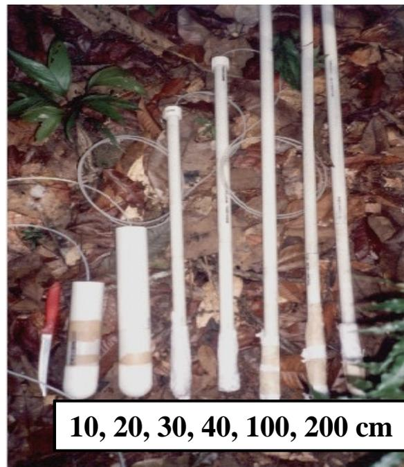
Figura 1. Bateria representativa das cápsulas extratoras de solução do solo instalados no experimento.
