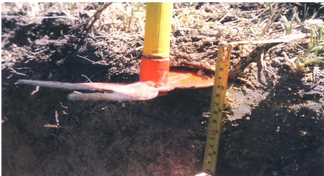
Figura 4. Delimitação das profundidades para coleta das amostras para o fracionamento físico da matéria orgânica do solo
