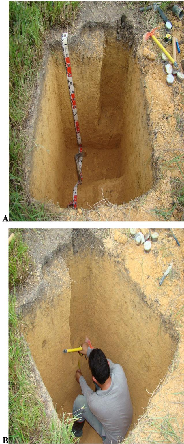
Figura 8. Identificação dos horizontes do solo (A) e camadas do solo (B)
