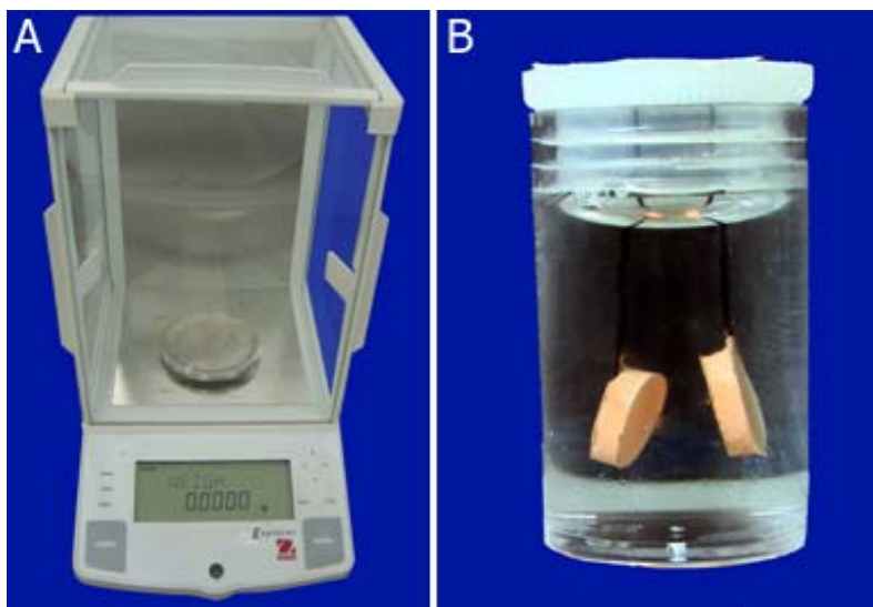
Figura 9. A) Balança de precisão HM-200. B) Corpos-de-prova no frasco contendo 7,5 mL de água deionizada e destilada.
