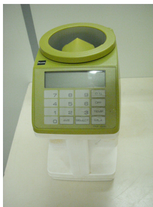
Figura 10 – Medidor dielétrico (Grainer II PM – 300) de umidade de grãos
