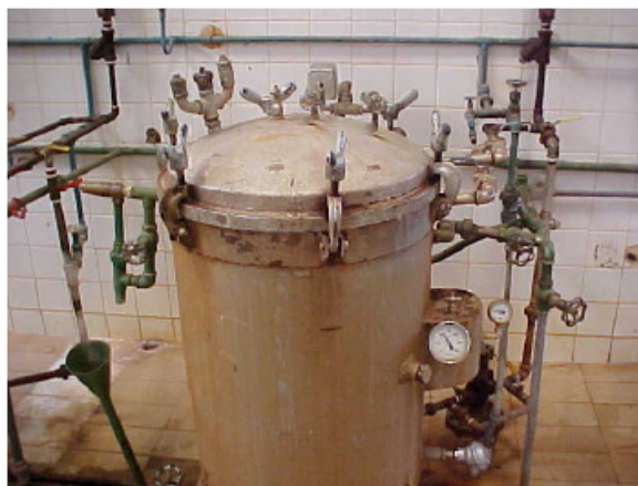
Figura 5. Autoclave utilizada para gelatinização dos grãos de arroz em casca Fonte: FERREIRA (2003)
