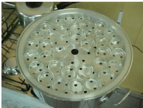
Figura 22 – Preparo das amostras utilizando panela Golden Kitchen Fonte: LIMA et al. (2006)
