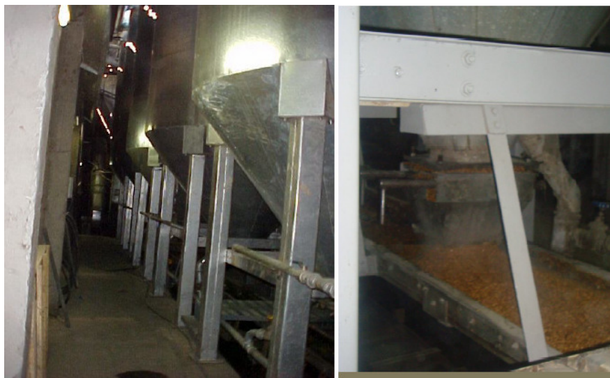
Figura 3. Tanques de encharcamento do arroz em casca Fonte: DARABAS (2009)
