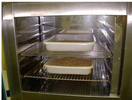
Figura 13 – Estufa com circulação de ar forçada para secagem do arroz autoclavado
