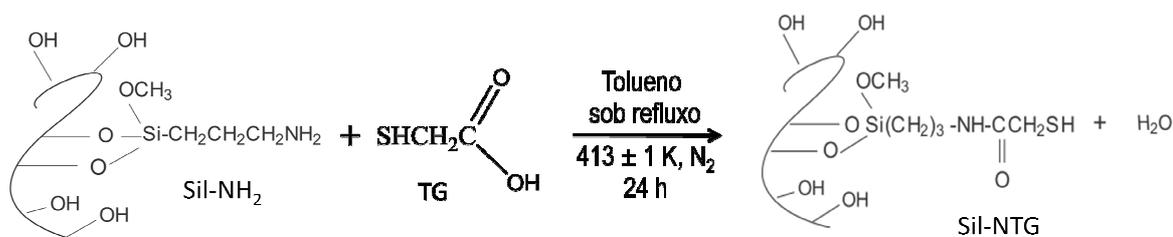
**Figura 4.3** - Esquema de síntese entre a Sil-NH<sub>2</sub> com o ácido tioglicólico.
