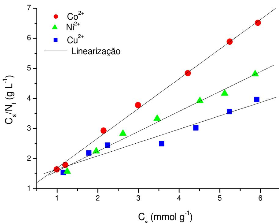
**Figura 5.30** - Forma linearizada das isotermas de adsorção dos cátions de cobre, cobalto e níquel na superfície Sil-NTGA em solução aquosa a  $298 \pm 1K$ , com  $pH = 7,0$  e força iônica constante,  $I = 0,05 \text{ mol L}^{-1}$ .
