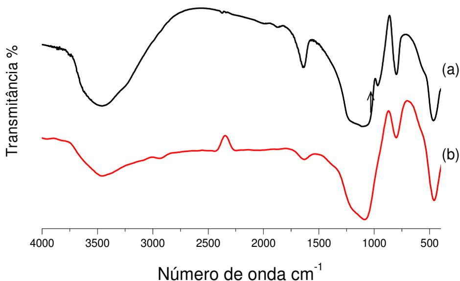
**Figura 5.8** - Espectro de absorção na região do infravermelho da sílica gel pura (a) e da Sil-AMPTGA (b).
