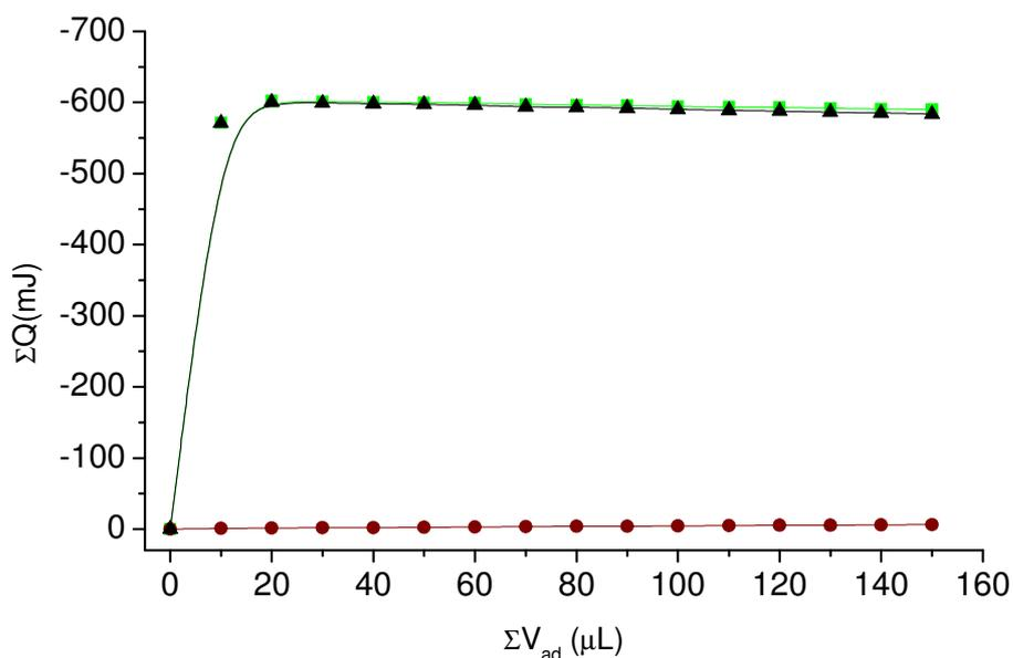
**Figura 5.32** – Gráficos da titulação calorimétrica de nitrato de níquel na superfície AMPTGA em solução aquosa a  $298,15 \pm 0,02$  K. Os dados experimentais representam o somatório dos efeitos térmicos da titulação  $\Sigma Q_t$  (-▲-), diluição  $\Sigma Q_d$  (-●-) e o efeito térmico resultante  $\Sigma Q_r$  (-■-).
