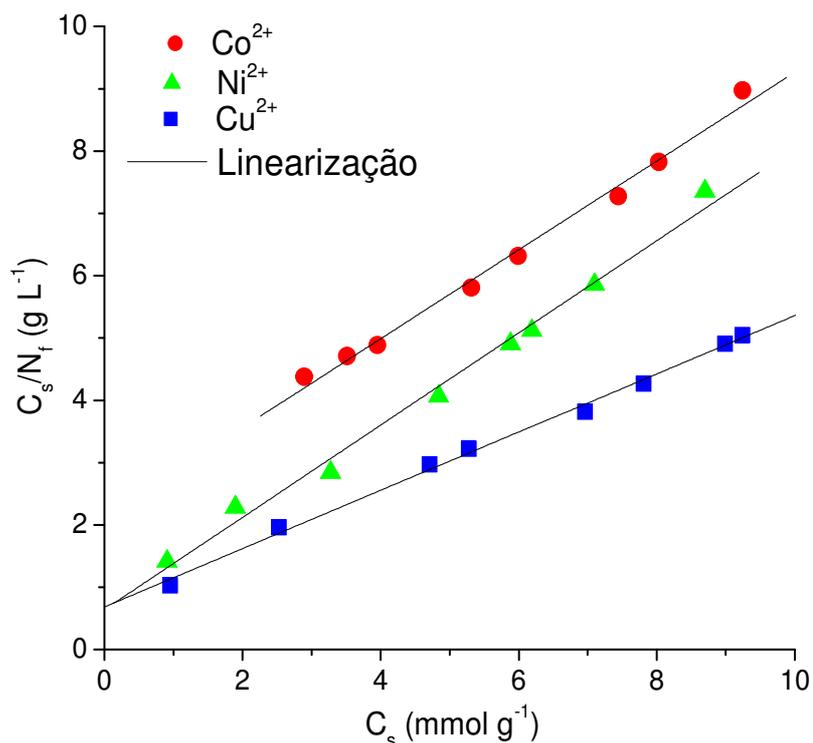
**Figura 5.23** - Forma linearizada das isotermas de adsorção dos cátions de cobre, níquel e cobalto na superfície Sil-NTGA em solução aquosa a  $298 \pm 1\text{K}$ .
