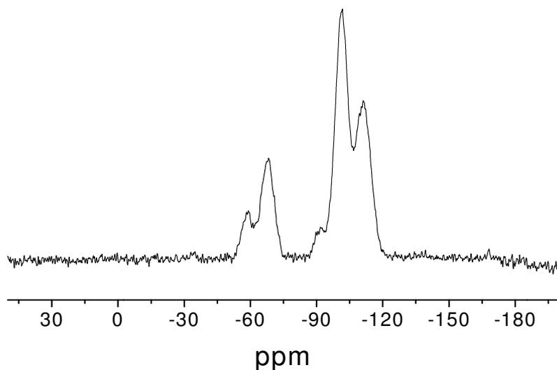
**Figura 5.11** - Espectro de RMN  $^{29}\text{Si}$  da sílica gel modificada (Sil-AMPTGA).
