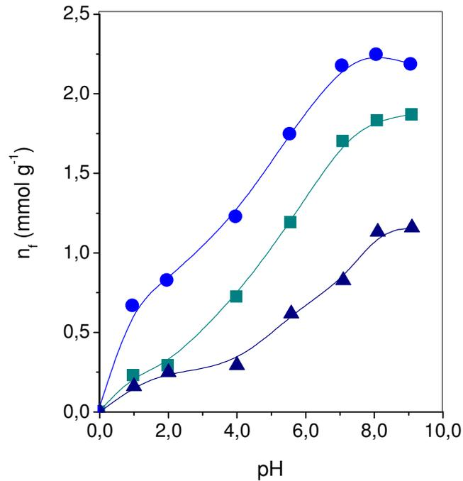
**Figura 5.25** - Isothermas de adsorção de cobre no sólido Sil-NTGA com força iônica igual a 0,05 (-●-); 0,1(-■-) e 0,5 mol L<sup>-1</sup> (-▲-), em diferentes pH a 298 ± 1K.
