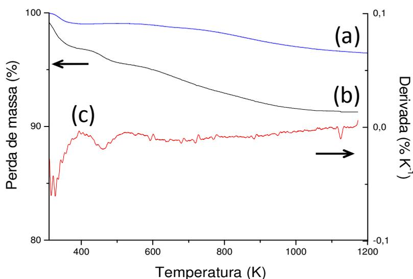
**Figura 5.13** - Curvas termogravimétricas da sílica gel pura (a), da Sil-AMPTGA (b) e sua derivada (c).
