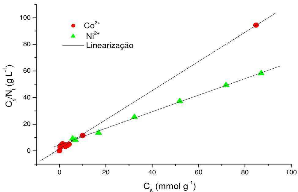
**Figura 5.21** - Linearização das isotermas de adsorção de cátions de cobalto e níquel na superfície Sil-AMPTGA em solução aquosa a  $298 \pm 1\text{K}$ .
