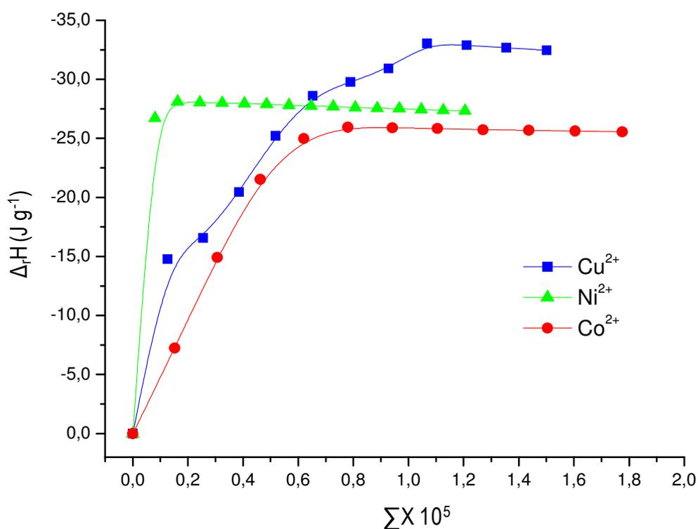
**Figura 5.34** – Isotermas da titulação calorimétrica de cátions de cobre, cobalto e níquel em solução aquosa na superfície AMPTGA a  $298,15 \pm 0,02$  K.
