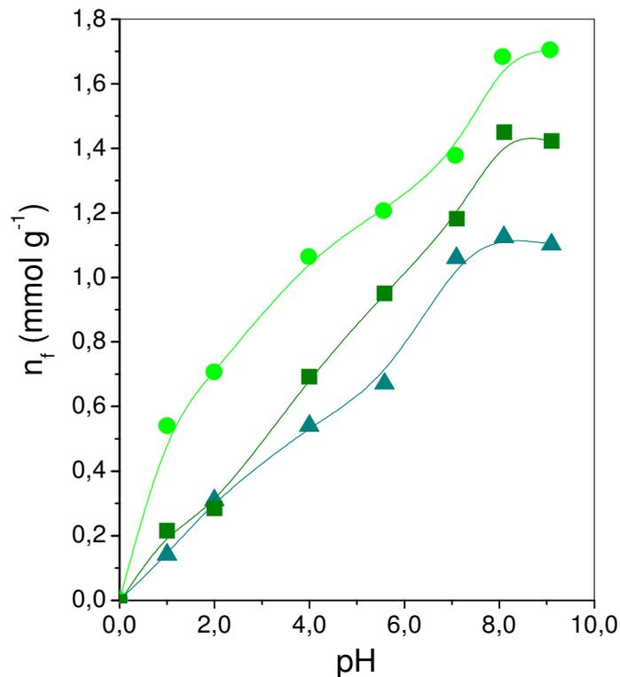
**Figura 5.26** - Isothermas de adsorção de níquel no sólido Sil-NTGA com força iônica igual a 0,05 (-●-); 0,1(-■-) e 0,5 mol L<sup>-1</sup> (-▲-), em diferentes pH e 298 ± 1K.
