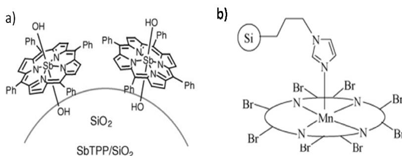
**Figura 3.15** – a) [Sb(TPP)Cl]<sup>+</sup> imobilizada em sílica gel pura via coordenação direta do metal à superfície do suporte (INOUE, 2005), e b) Mn(Br<sub>8</sub>TPP)Cl imobilizada em sílica funcionalizada via coordenação do metal ao grupo imidazol covalentemente ligado ao suporte (KARGAR, 2008).
