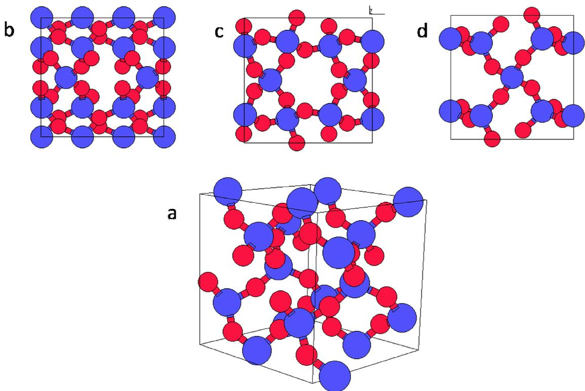
**Figura 3.2** - Estrutura reticular do quartzo vista em perspectiva (a), vista de cima (b), vista de frente (c) e vista do lado direito (d).
