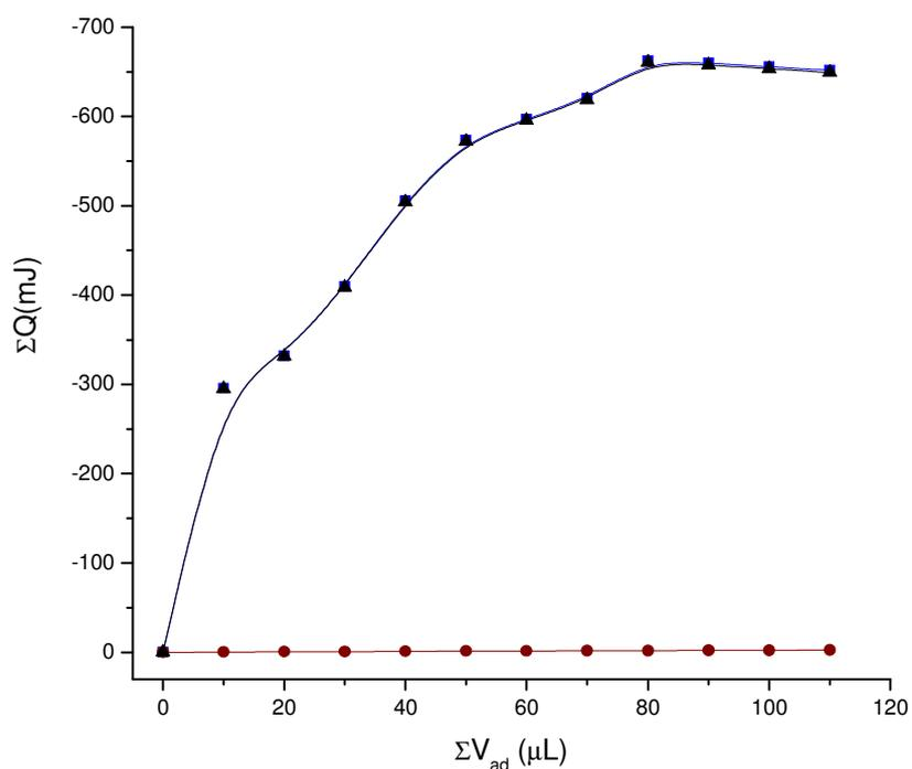
**Figura 5.31** – Gráficos da titulação calorimétrica de nitrato de cobre na superfície AMPTGA em solução aquosa a  $298,15 \pm 0,02$  K. Os dados experimentais representam o somatório dos efeitos térmicos da titulação  $\Sigma Q_t$  (-▲-), diluição  $\Sigma Q_d$  (-●-) e o efeito térmico resultante  $\Sigma Q_r$  (-■-).
