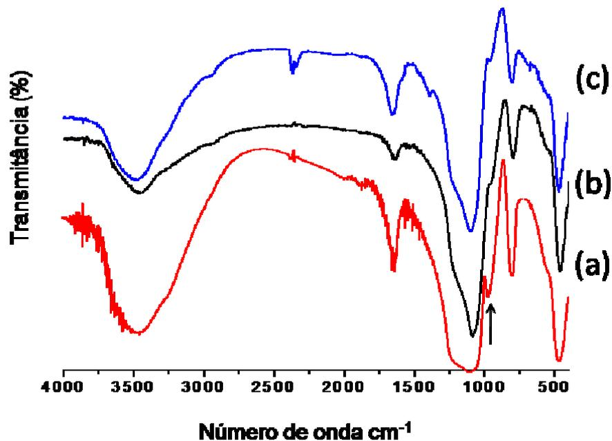
**Figura 5.14** - Espectros de absorção na região do infravermelho da sílica gel pura (a) e das superfícies Si-NH<sub>2</sub> (b) e Si-NTGA (c).
