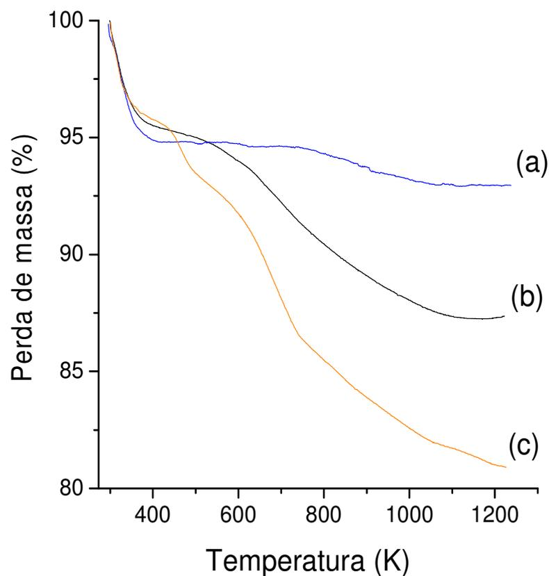
**Figura 5.17** - Curvas termogravimétricas da sílica gel ativada (a) e das superfícies Si-NH<sub>2</sub> (b) e Si-NTGA (c).
