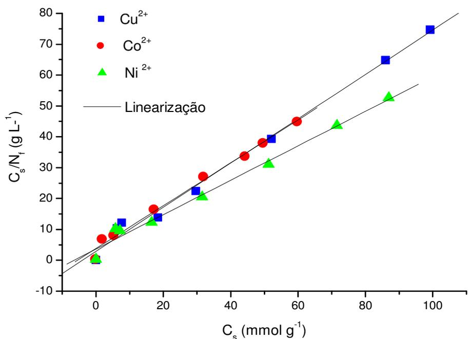
**Figura 5.19** - Linearização das isothermas de adsorção de cátions de cobre, cobalto e níquel na superfície AMPTGA em solução aquosa a  $298 \pm 1K$ .
