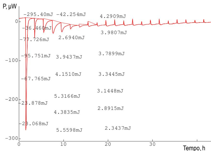
**Figura 4.4** – Gráfico da potência (P) em função do tempo (t), que registra os efeitos térmicos de interação da solução aquosa de nitrato de cobre com a superfície AMPTGA.
