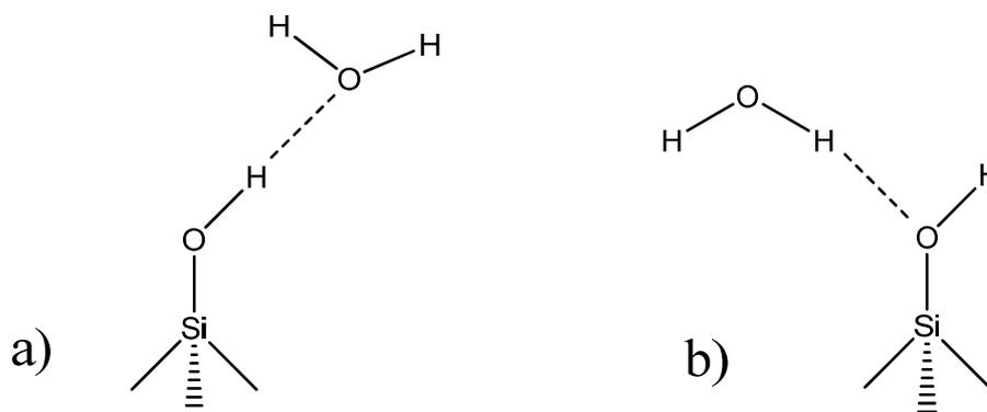
**Figura 3.10** – Ligação entre os grupos silanóis e moléculas de água.
