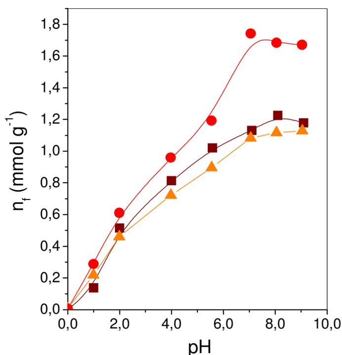
**Figura 5.24** - Isotermas de adsorção de cobalto no sólido SiL-NTGA com força iônica igual a 0,05 (-●-); 0,1(-■-) e 0,5 mol L<sup>-1</sup> (-▲-), em diferentes pH a 298 ± 1K.
