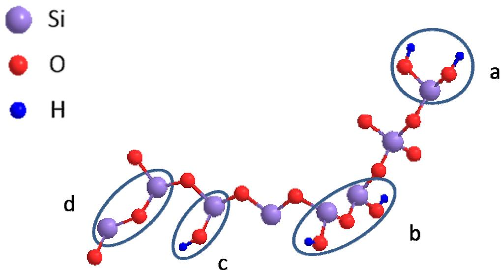
**Figura 3.8** – Representação da superfície da sílica gel destacando os grupos silanóis geminais (a), silanóis vicinais (b), silanóis isolados (c) e siloxanos (d).
