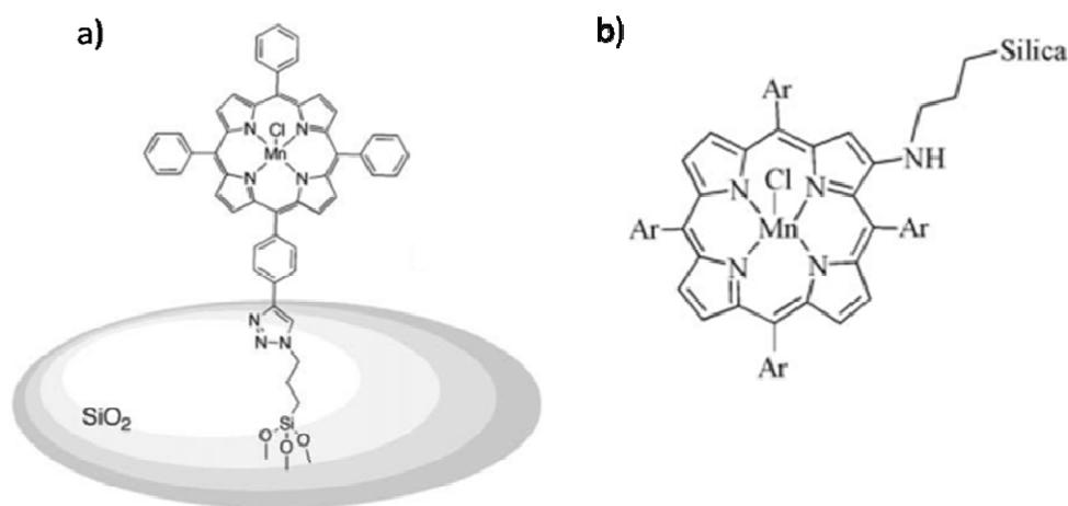
**Figura 3.14** – a) Mn(TPP)Cl coordenada com sílica funcionalizada via ligante da posição *meso* (FRANSSEN, 2009) ou b) via ligação pela posição  $\beta$ -pirrólica do macrociclo (CAVALEIRO, 2006).
