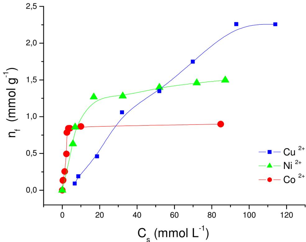
**Figura 5.20** - Isotermas de adsorção dos cátions de cobre, níquel e cobalto na superfície Sil-AMPTGA em solução aquosa a  $298 \pm 1\text{K}$ .
