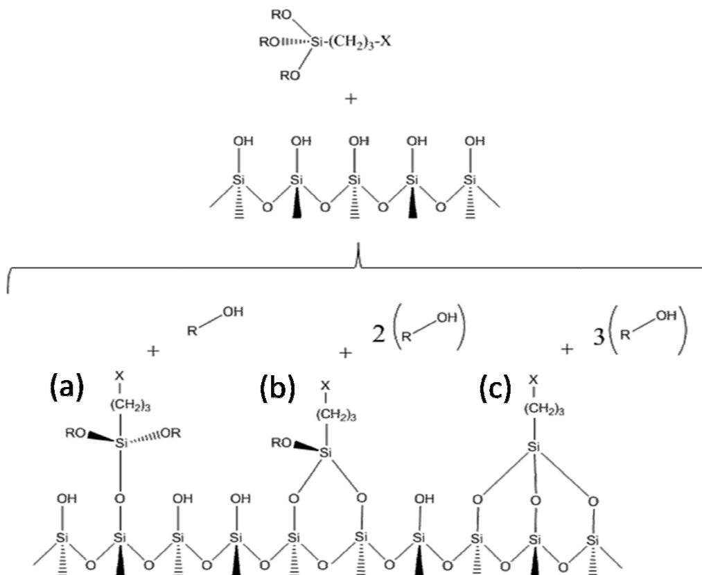
**Figura 3.11** - Esquema representativo de ancoramento dos organossilanos na superfície da sílica, nas diferentes formas: (a) monodentado; (b) bidentado e (c) tridentado.
