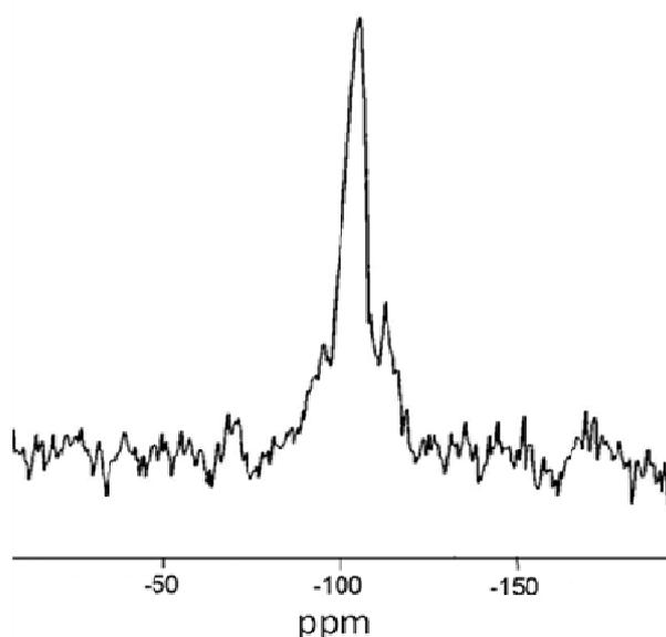
**Figura 5.10** - Espectro de RMN  $^{29}\text{Si}$  da sílica gel ativada.
