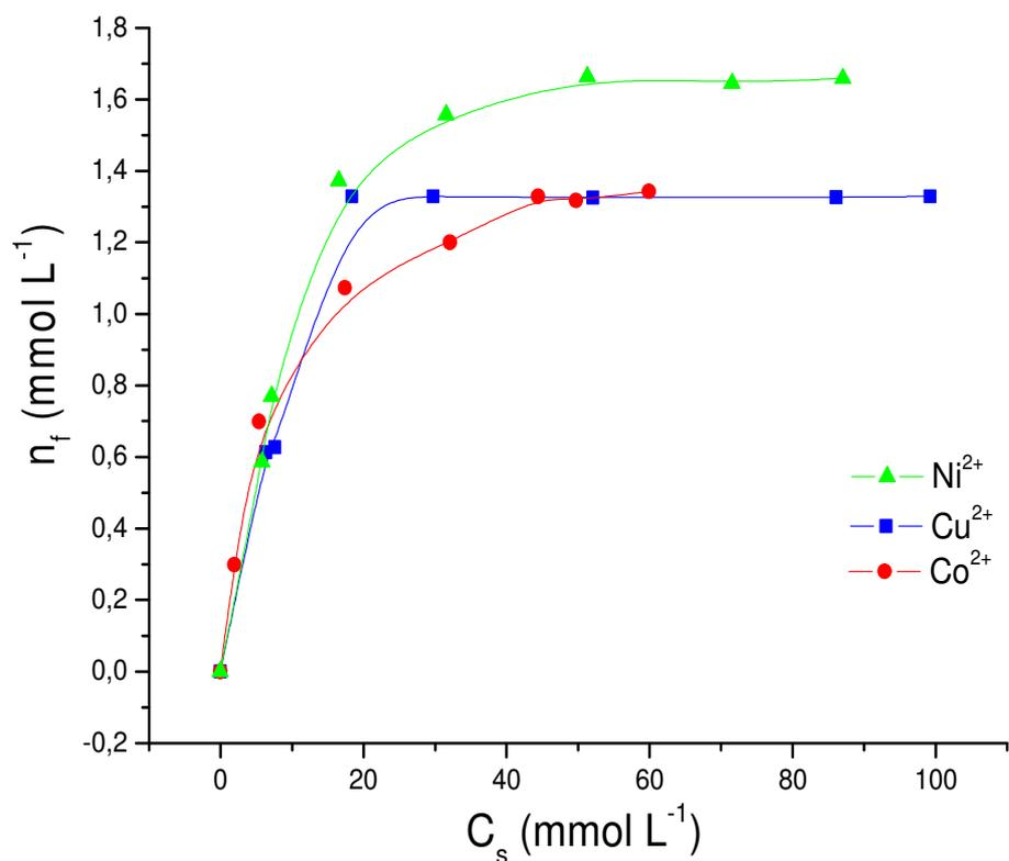
**Figura 5.18** - Isothermas de adsorção dos cátions cobre, cobalto e níquel na superfície AMPTGA em solução aquosa a  $298 \pm 1K$ .
