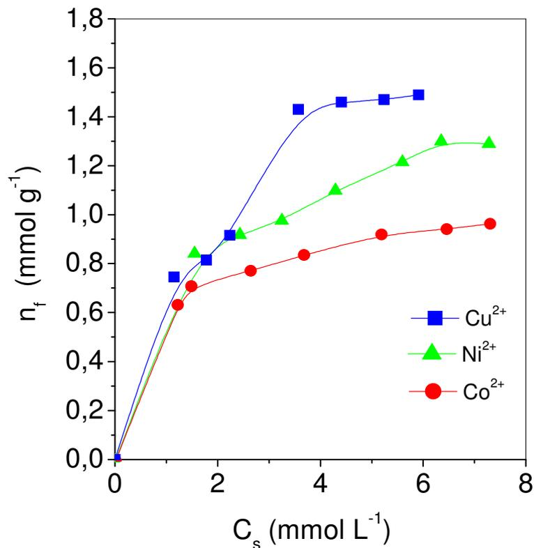
**Figura 5.29** - Isotermas de adsorção de cátions de cobre, cobalto e níquel na superfície Sil-NTGA em solução aquosa a  $298 \pm 1K$ , com  $pH = 7,0$  e força iônica constante,  $I = 0,05 \text{ mol L}^{-1}$ .
