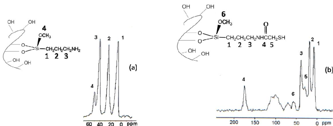
**Figura 5.15** - Espectro RMN-CPMAS de  $^{13}\text{C}$  das sílicas modificadas  $\text{Si-NH}_2$  (a), e  $\text{Si-NTGA}$  (b).
