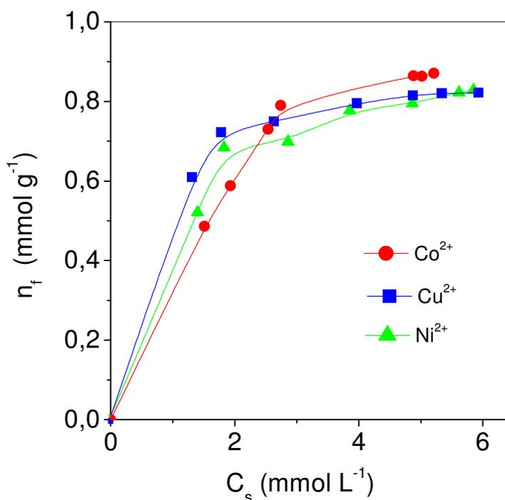
**Figura 5.27** - Isotermas de adsorção de cátions de cobre, cobalto e níquel na superfície Sil-NTGA em solução aquosa a  $298 \pm 1\text{K}$ , com pH = 4,0 e força iônica constante,  $I = 0,05 \text{ mol L}^{-1}$ .
