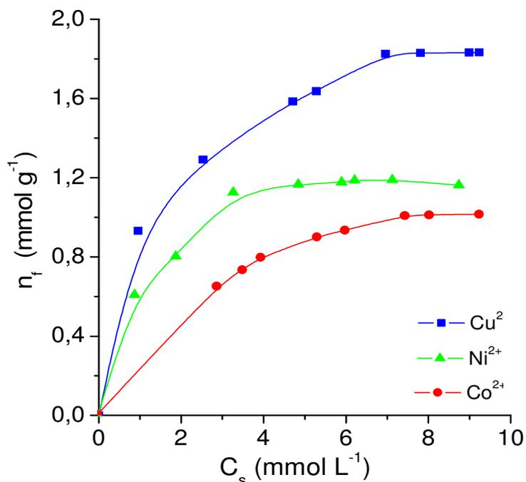
**Figura 5.22** - Isotermas de adsorção dos cátions de cobre, níquel e cobalto na superfície Sil-NTGA em solução aquosa a 298 ± 1K.
