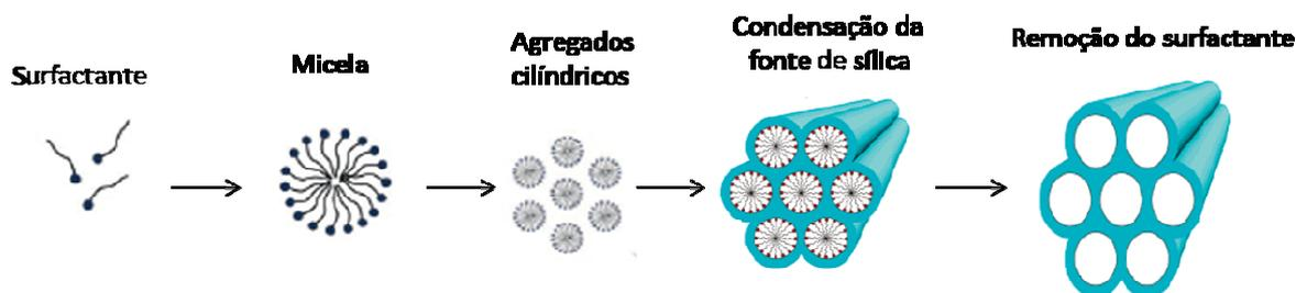
**Figura 3.7** – Esquema de síntese da sílica mesoporosa.
