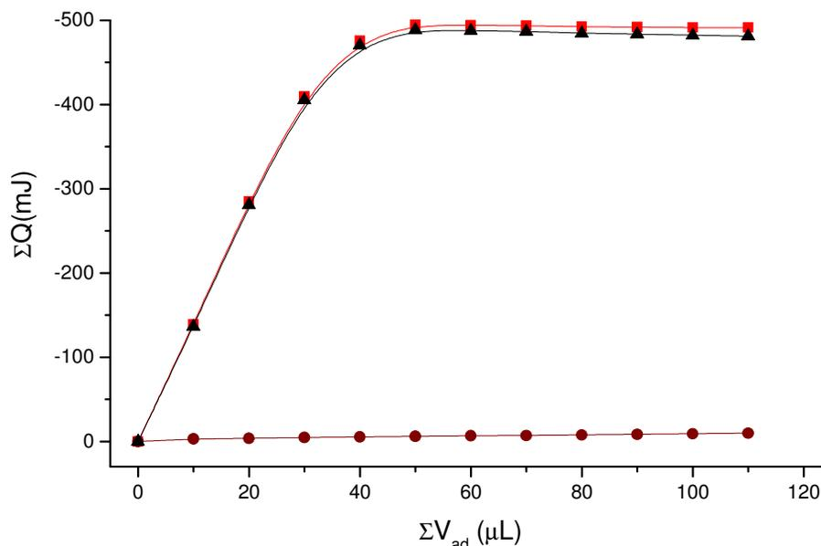
**Figura 5.33** – Gráficos da titulação calorimétrica de nitrato de cobalto na superfície AMPTGA em solução aquosa a  $298,15 \pm 0,02$  K. Os dados experimentais representam o somatório dos efeitos térmicos da titulação  $\Sigma Q_t$  (-▲-), diluição  $\Sigma Q_d$  (-●-) e o efeito térmico resultante  $\Sigma Q_r$  (-■-).
