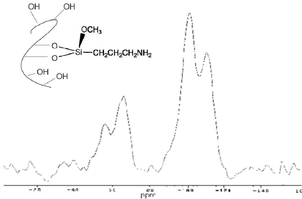
**Figura 5.16** - Espectro de RMN-CPMAS de  $^{29}\text{Si}$  da  $\text{Si-NH}_2$ .
