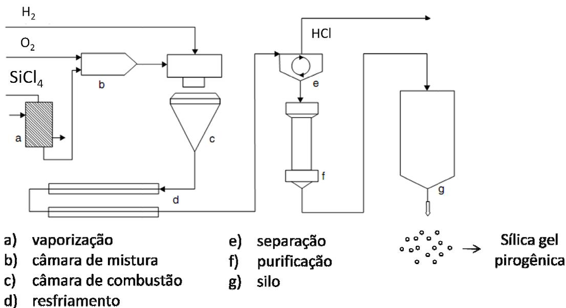
**Figura 3.6** – Processo de produção de sílica gel pirogênica.
