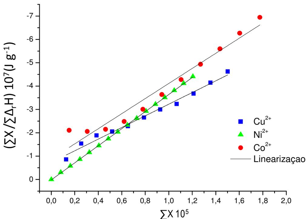
**Figura 5.35** – Linearização das isotermas calorimétricas dos cátions de cobre, cobalto e níquel em solução aquosa na superfície AMPTGA a  $298,15 \pm 0,02$  K.
