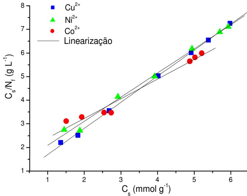
**Figura 5.28** - Forma linearizada das isotermas de adsorção dos cátions de cobre, cobalto e níquel na superfície Sil-NTGA em solução aquosa a  $298 \pm 1K$ , com  $pH = 4,0$  e força iônica constante,  $I = 0,05 \text{ mol L}^{-1}$ .
