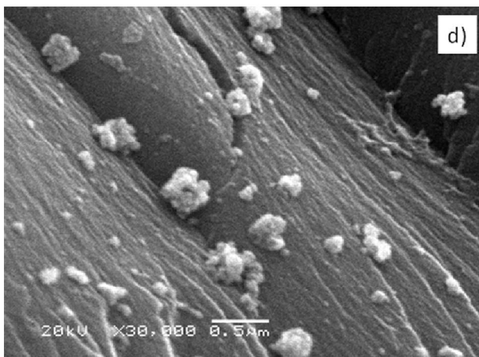
**Figura 5.7** - Microscopias eletrônicas de varredura referentes ao AMPTGA complexado com cobre, ampliado 500 (a), 2000 (b), 10.000 (c) e 30.000 vezes (d).
