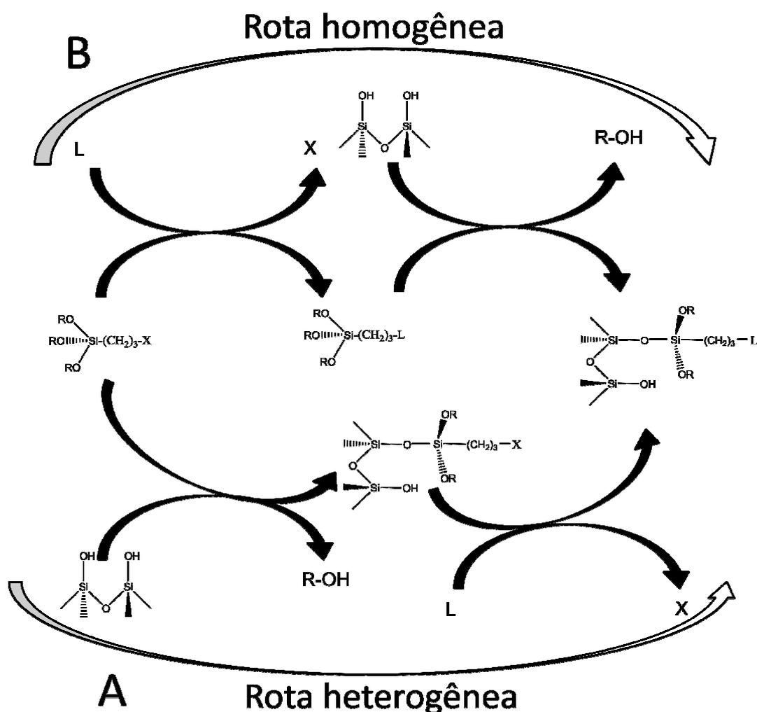
**Figura 3.12** – Rota de imobilização de um agente sililante sobre a superfície da sílica, pela rota heterogênea, rota A, e rota homogênea, rota B.
