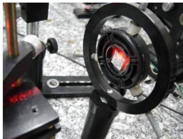
Figura 5-13 - *Tweeter* piezoelétrico utilizado nos experimentos.
