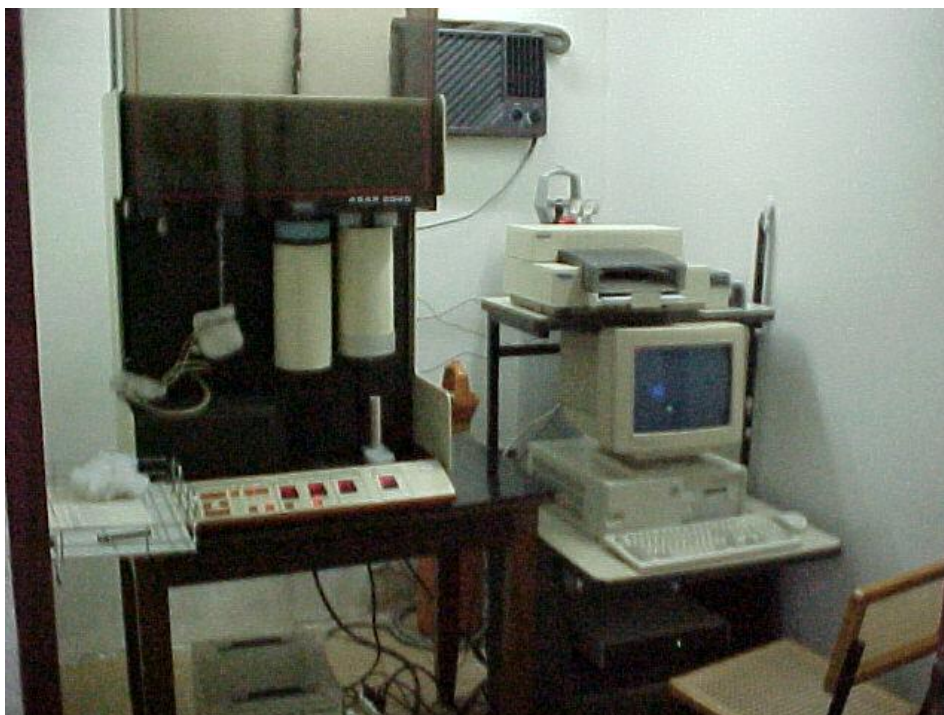
Figura 15 - Analisador de área superficial, da marca Micromeritics e modelo ASAP 2010.
