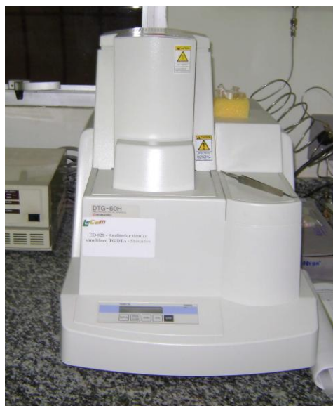
Figura 16 - TG/DTA simultâneas, termobalança, marca Shimadzu, modelo DTG60H.
