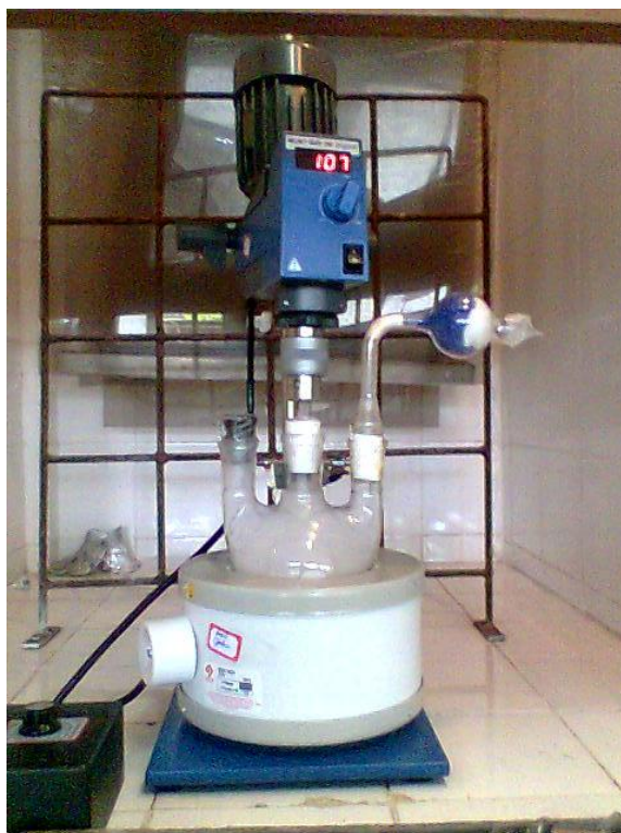
Figura 13 - Sistema usado para a modificação da superfície SiI2N com aldeído fórmico.
