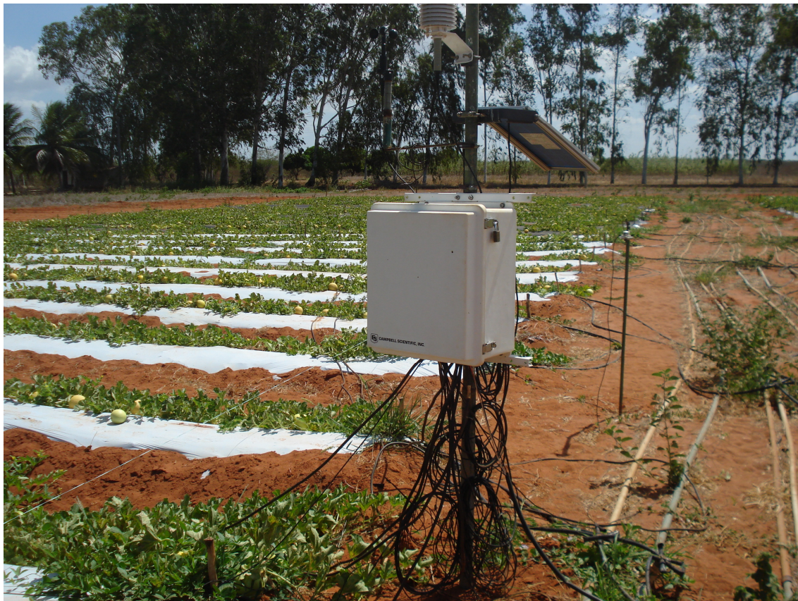
Figura 4. Estação Agrometeorológica automática instalada na área experimental. Mossoró - RN, 2009.
