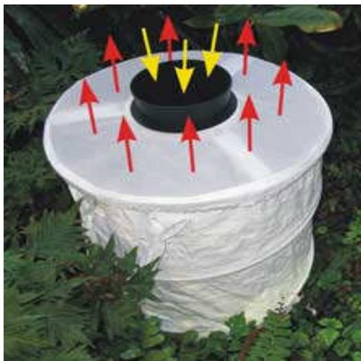
FIGURA 14 – Armadilha BG-Sentinela®. Demonstração do fluxo de ar do atraente do odor humano sintético saindo da armadilha (setas vermelhas) e a sucção dos mosquitos (setas amarelas)
