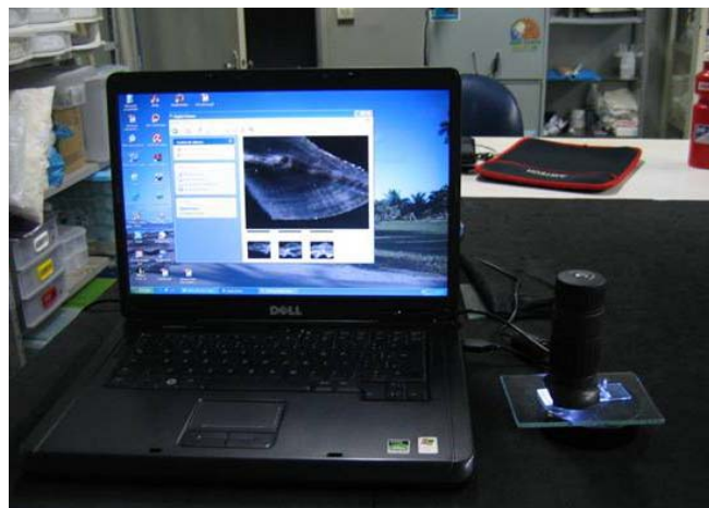
Figura 8. Obtenção das imagens dos otólitos através da câmera digital (Microscope câmera 130x USB).
