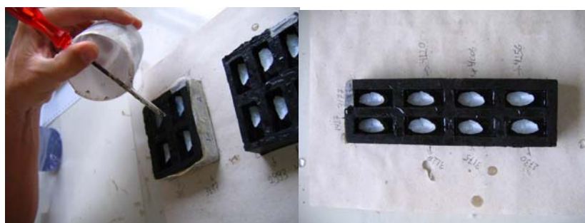
Figura 5. Processamento das amostras. Etapa de inclusão em resina para subsequente corte dos Otólitos.
