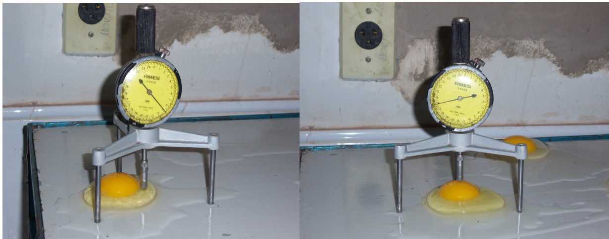
Figura 5 - Medição da altura (mm) do albúmen (A) e da gema (B) utilizando micrômetro tripé.
