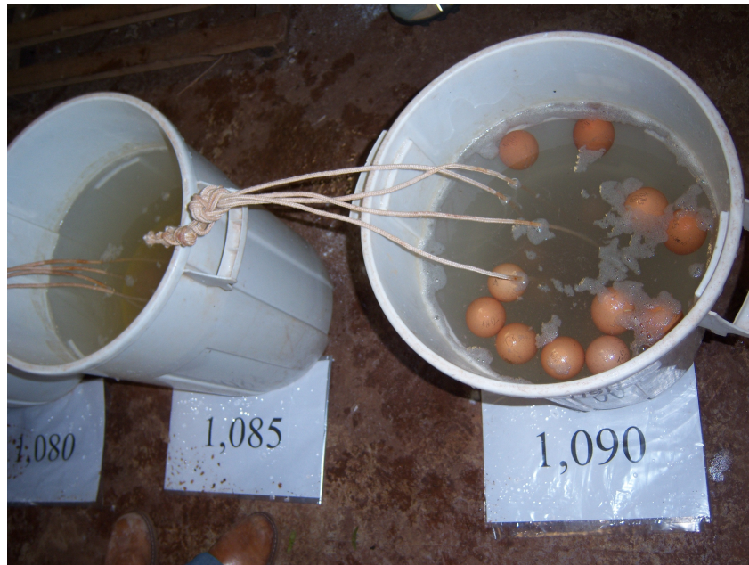
Figura 4 – Avaliação da densidade dos ovos em diferentes soluções salinas.
