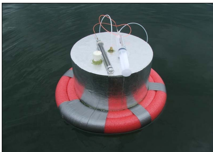
Figura 2.19 – Exemplo de câmara estática usada para medições de GEE.
