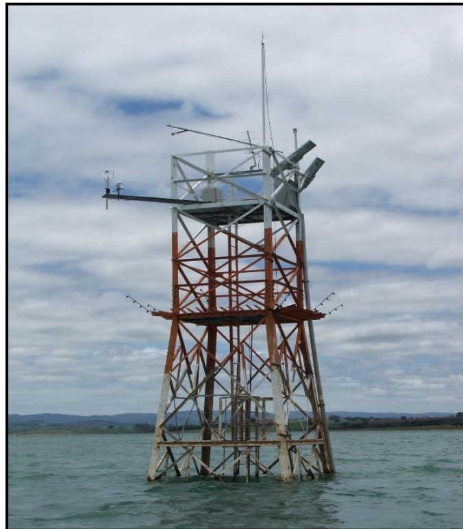
Figura 2.18 – Fotografia de uma torre micrometeorológica, onde está instalado um analisador de CO 2 /H 2 O, implantado no reservatório de Furnas, município de Guapé/MG.
