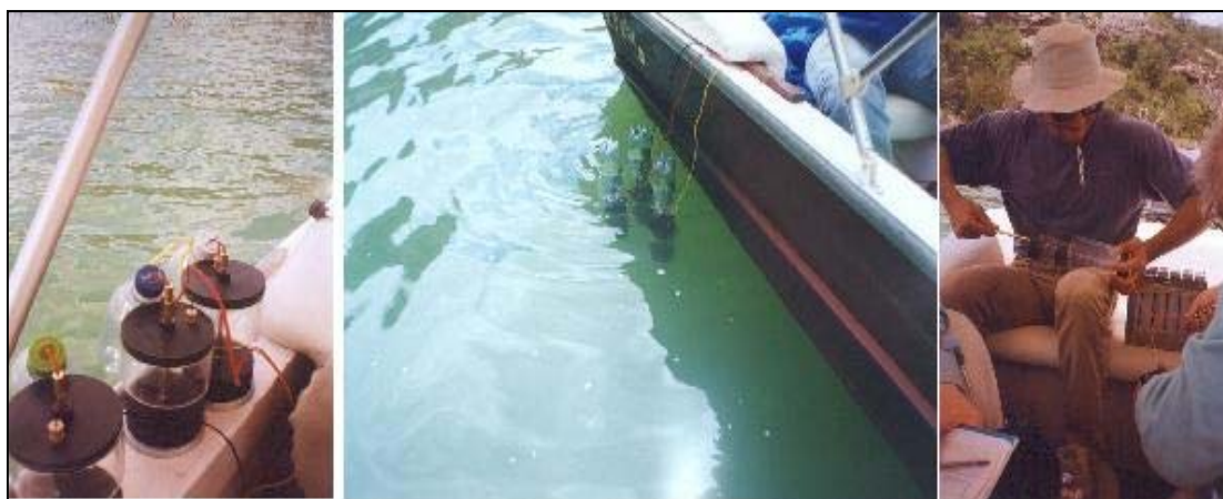
Figura 2.21 – Procedimentos de uso das câmaras de difusão em experimentos de equalibração (Fonte: SANTOS et al. , 2003).
