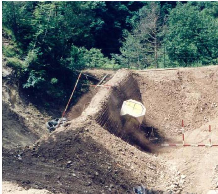
Figura 2.18 – Dique de solo reforçado (Peila et al., 1998).
