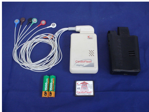
Figura 1. Fotografia do eletrocardiógrafo holter digital de três canais, ilustrando além do aparelho, o cartão de memória, as pilhas e capa de proteção. Unesp, Jaboticabal, 2009.
