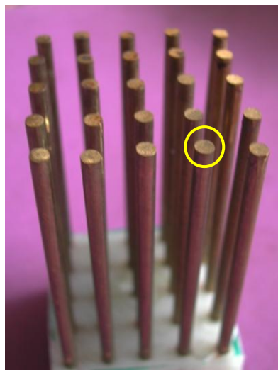
Figura 1 - Replicador de Steer. A seção transversal de 3mm, assinalada pelo círculo corresponde à área que carrega 10^4 bactérias a serem semeadas.
