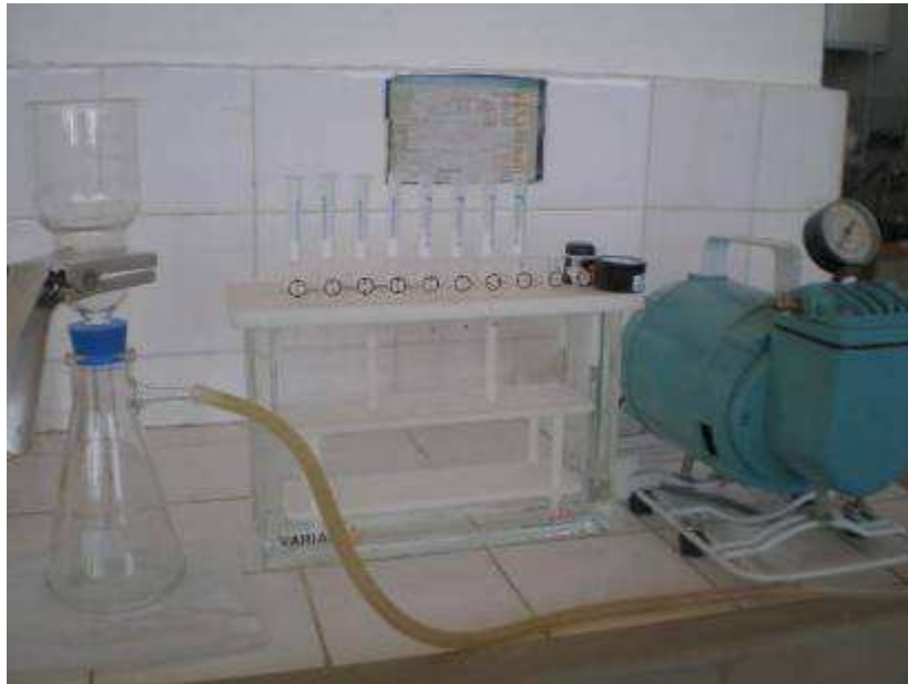
Figura 8: Filtragem e extração em fase sólida das amostras, empregando cartuchos de polipropileno C 18 e CN.
