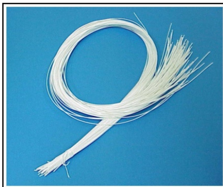
Figura 3.7: Feixe de membranas microporosas de geometria cilíndrica do tipo fibra oca.
