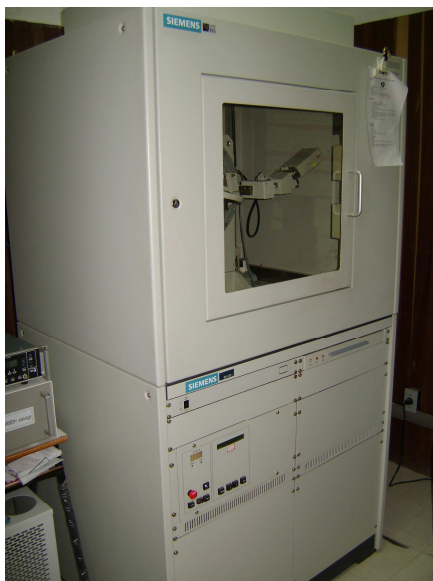
Figura 17. Difratormetro utilizado para as análises de DRX.
