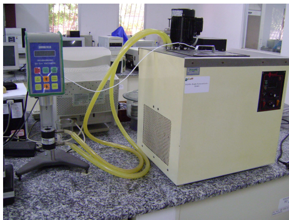
Figura 20. Viscosímetro utilizado para as análises de viscosidade dinâmica dos biodieseis.
