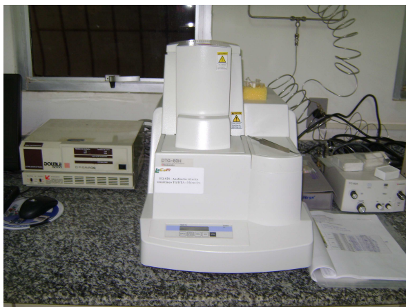
Figura 14. Termobalança utilizada para as análises das curvas termogravimétricas.
