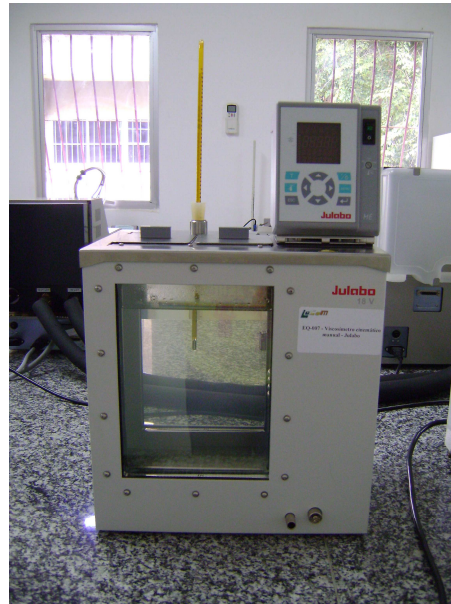
Figura 21. Viscosímetro utilizado para as análises de viscosidade cinemática dos biodiseis.
