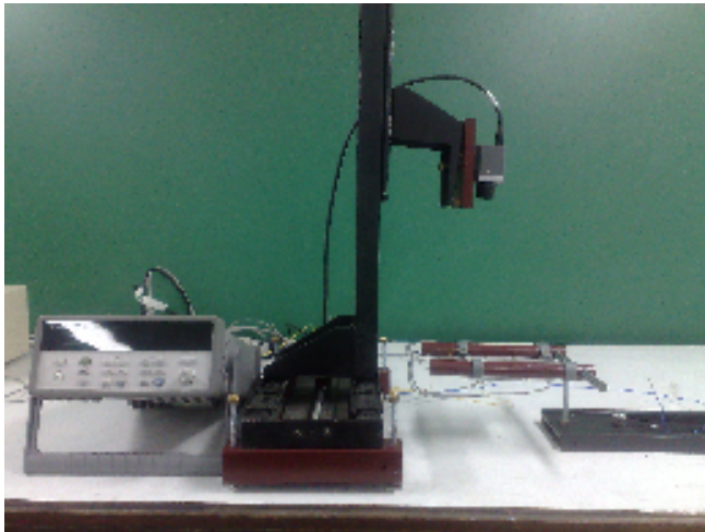
Figs. 5.3– Experimento de placa horizontal, com detalhe do dispositivo de posicionamento vertical da câmera e do porta-amostras.
