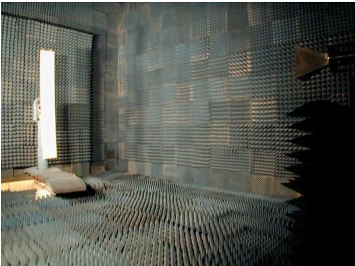
*Figura 17 Isolamento de uma câmara anecóica.*
