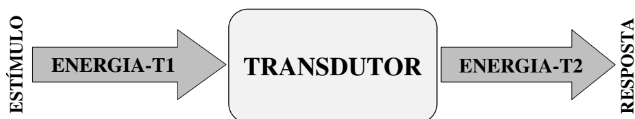
Figura 2.1: Fluxo de energia e estímulo/resposta do sensor transdutor.
