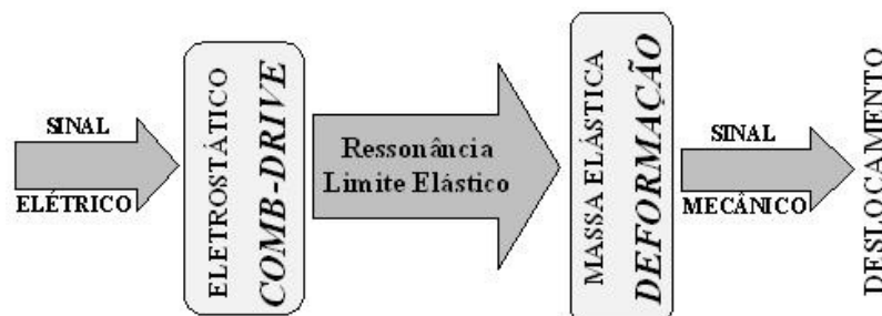
Figura 2.5: Atuador MEMS elasto-deformável e ação eletrostática.
