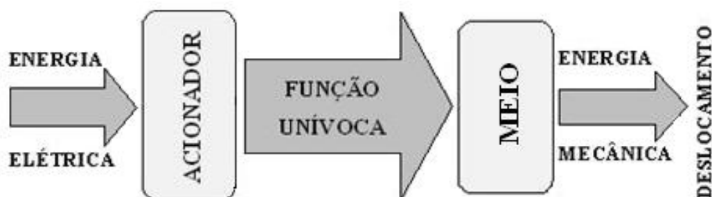
Figura 2.4: Atuador eletromecânico em diagrama de blocos.
