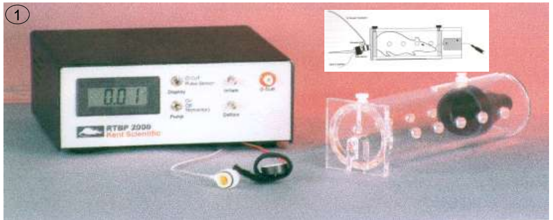
Anexo 1: Representação esquemática do aparelho utilizado para a medida de pressão arterial caudal.
