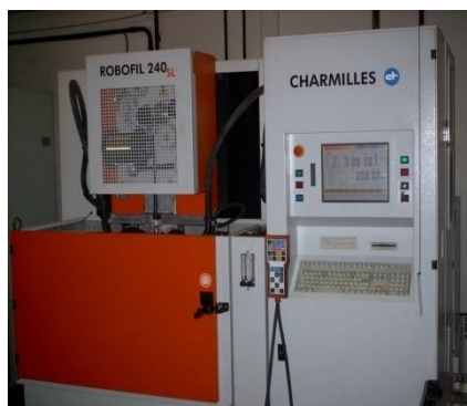
Figura 4.2 – Máquina para corte submerso por eletroerosão a fio Robofil 240 SL Charmilles.
