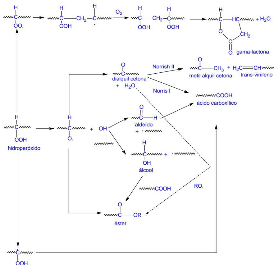
**Figura 5.13:** Esquema do processo oxidativo do PEUAPM. Adaptado de TADDEI *et al.*, 2006.
