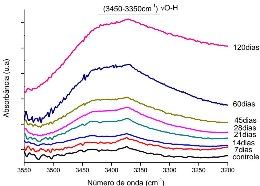
**Figura 5.10:** Espectro de FTIR do PEUAPM\_Ox em peróxido de hidrogênio até 120 dias destacando o grupamento hidroperóxido.
