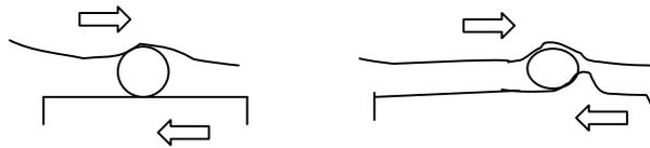
**Figura 3.4:** Mecanismo de desgaste de terceiro corpo (adaptado de NEVELOS *et al.*, 2004).
