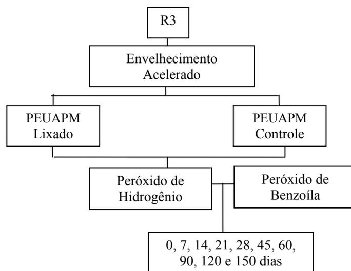
**Figura 4.7:** Fluxograma do caminho 3 (R3) seguido para a obtenção da oxidação do PEUAPM.
