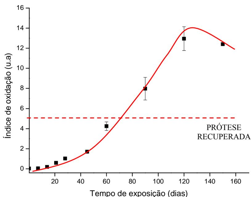
**Figura 5.20:** Gráfico índice de oxidação versus tempo do PEUAPM<sub>Ox</sub> em H<sub>2</sub>O<sub>2</sub>.
