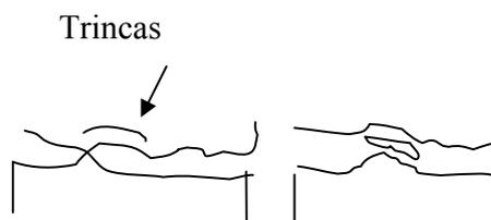
**Figura 3.5:** Mecanismo de desgaste por fadiga (adaptado de NEVELOS *et al.*, 2004).
