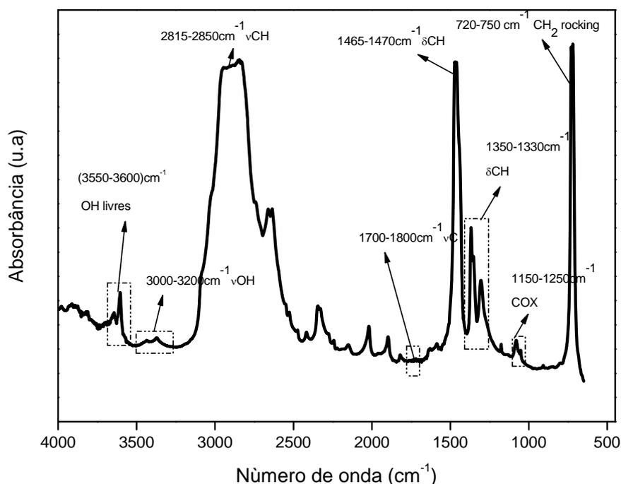
**Figura 5.3:** Espectro típico de FTIR do PEUAPM controle.
