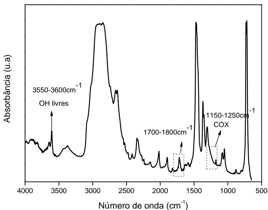
**Figura 5.6:** Espectro típico de FTIR do PEUAPM oxidado 21 dias em H<sub>2</sub>O<sub>2</sub>.
