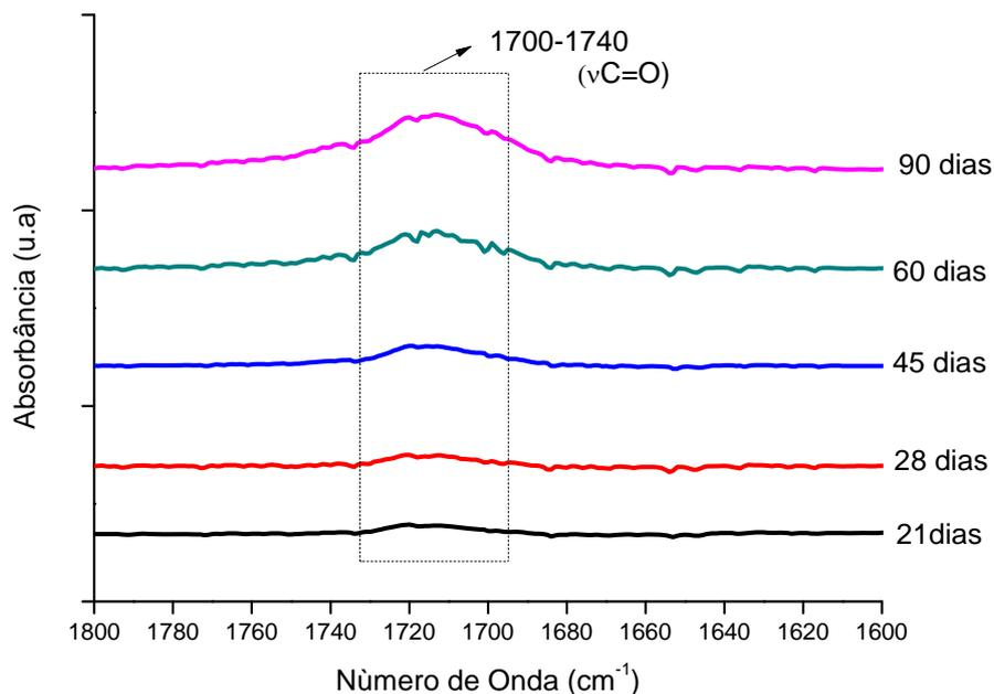
**Figura 5.30:** Espectro de FTIR do PEUAPM\_600 oxidado em H<sub>2</sub>O<sub>2</sub> enfatizando o grupamento carbonila.
