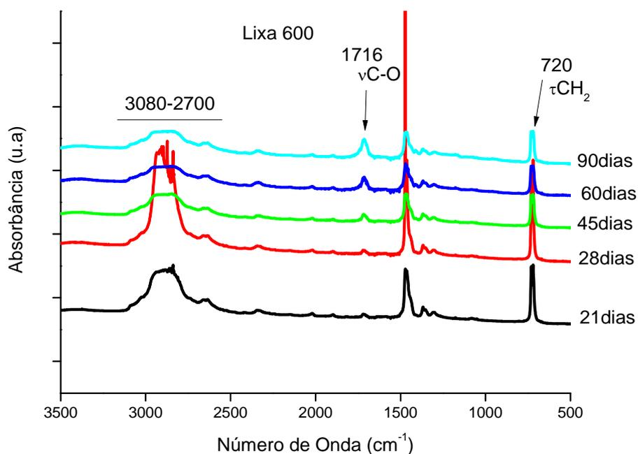
**Figura 5.29:** Espectro de FTIR do PEUAPM\_600 oxidado em H<sub>2</sub>O<sub>2</sub>.
