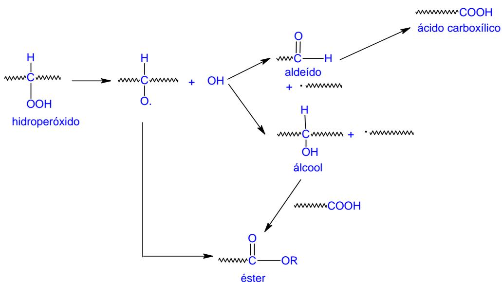
**Figura 5.11:** Mecanismo de formação de outros produtos de oxidação do PEUAPM. Adaptado de TADDEI *et al.*, 2006.
