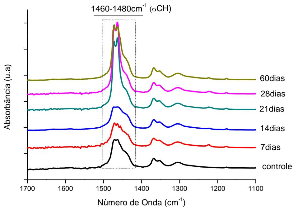
**Figura 5.27:** Espectro de FTIR do PEUAPM-Ox com peróxido de benzoíla destacando a banda de interesse  $1400\text{-}1500\text{cm}^{-1}$ .
