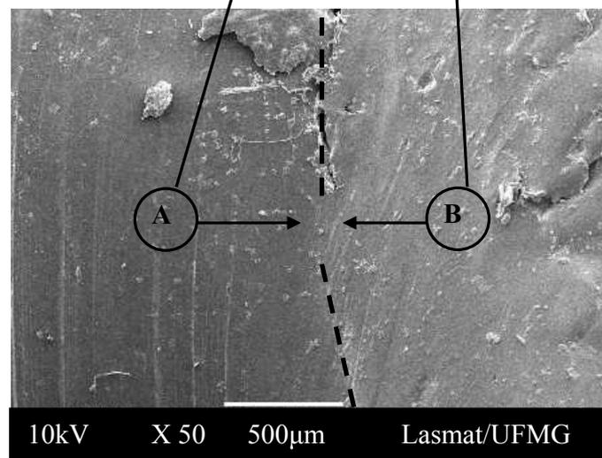
**Figura 5.34:** Imagem de MEV em ampliação de 50X do PEUAPM recuperado evidenciando a zona branca de transição com o lado (a) representando a região mais oxidada e o lado (b) mais rugoso refere-se à região de menor oxidação.
