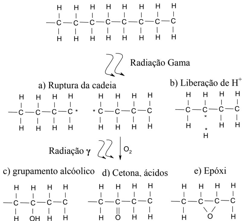
**Figura 3.1:** Representação da cadeia polimérica rompida após irradiação e da combinação com O<sub>2</sub> de modo a facilitar a degradação oxidativa do PEUAPM; a) ruptura da cadeia; b) a liberação de H; c) a formação de álcool; d) a formação de carbonila; e) a formação de épxi. Adaptado de *The Journal of Bone and Joint Surgery*, 2001.
