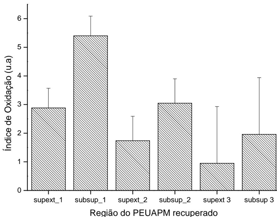
**Figura 5.40:** Gráfico dos índices de oxidação das regiões analisadas do PEUAPM\_Re: superfície da região 1 (supext\_1); sub-superfície da região 1 (subsup\_1); superfície da região 2 (supext\_2); sub-superfície da região 2 (subsup\_2); superfície da região 3 (supext\_3); sub-superfície da região 3 (subsup\_3) .
