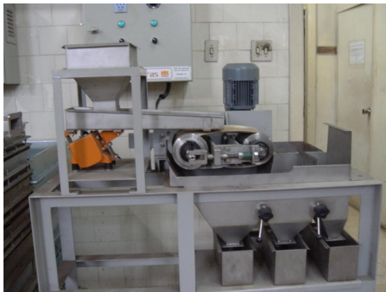
Figura 4.7: Separador magnético de tambor de terras raras com campo de 7500Gauss, da Inbras.
