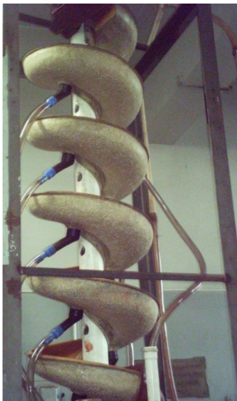
Figura 4.2: Espiral Modelo WW6E da Roche Mining utilizada nos testes.
