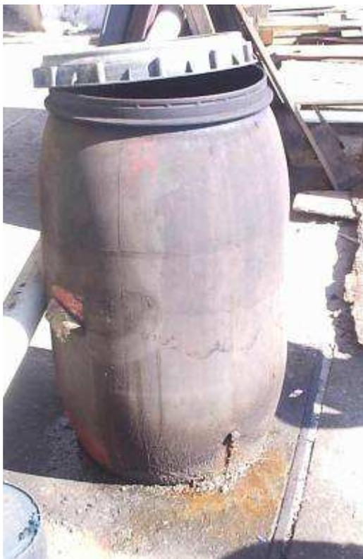
Figura 8 – Coletor de óleo em local inadequado.
