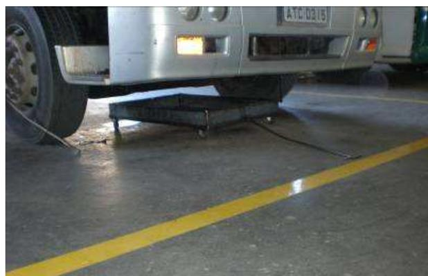
Figura 7 –Empresa com o piso limpo e o uso de bandeja de contenção de óleo.
