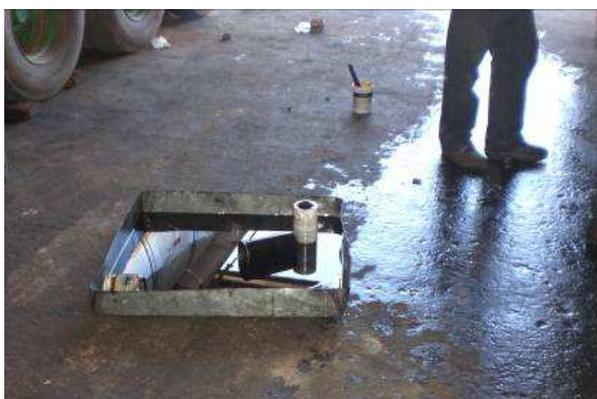
Figura 6 - Apesar do uso de bandeja, existem derrame de óleo no piso.
