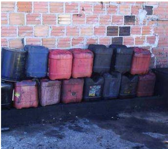
Figura 9 – Armazenamento de embalagens de óleo de forma incorreta, com contaminação do piso.
