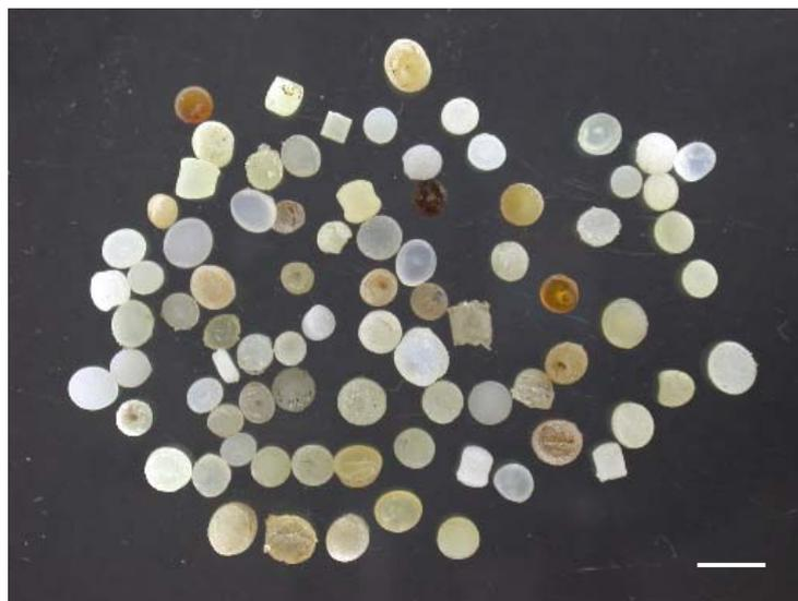
Figura 1. “Plastic Pellets” coletados em Santos. (Fonte: A. Turra; Escala: 5 mm)
