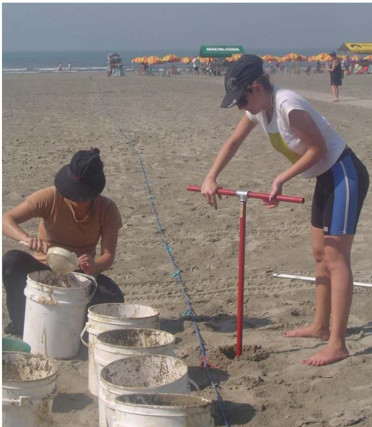
Figura 6. Procedimentos de coleta para avaliar a distribuição ao largo (vertical) da Enseada de Santos utilizando uma cavadeira tipo trado de 6' de diâmetro.
