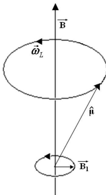
Figura 2.2: Movimento de precessão do momento magnético angular do spin  $\hat{\mu}$ , em torno da direção em que é aplicado o campo externo  $\vec{B}$  com velocidade de precessão de Larmor  $\hat{\omega}_L$
