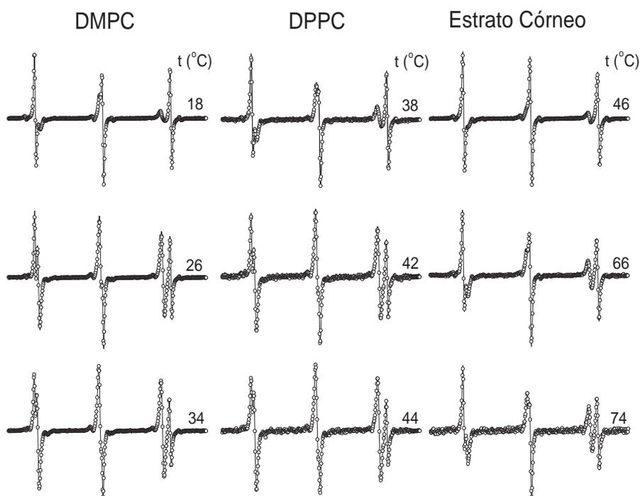
Figura 4.2: Espectro de RPE experimental (linha) e simulado (círculos abertos) do DTBN em membranas de DMPC, DPPC e estrato córneo para várias temperaturas. A varredura de campo magnético é de 50 G.
