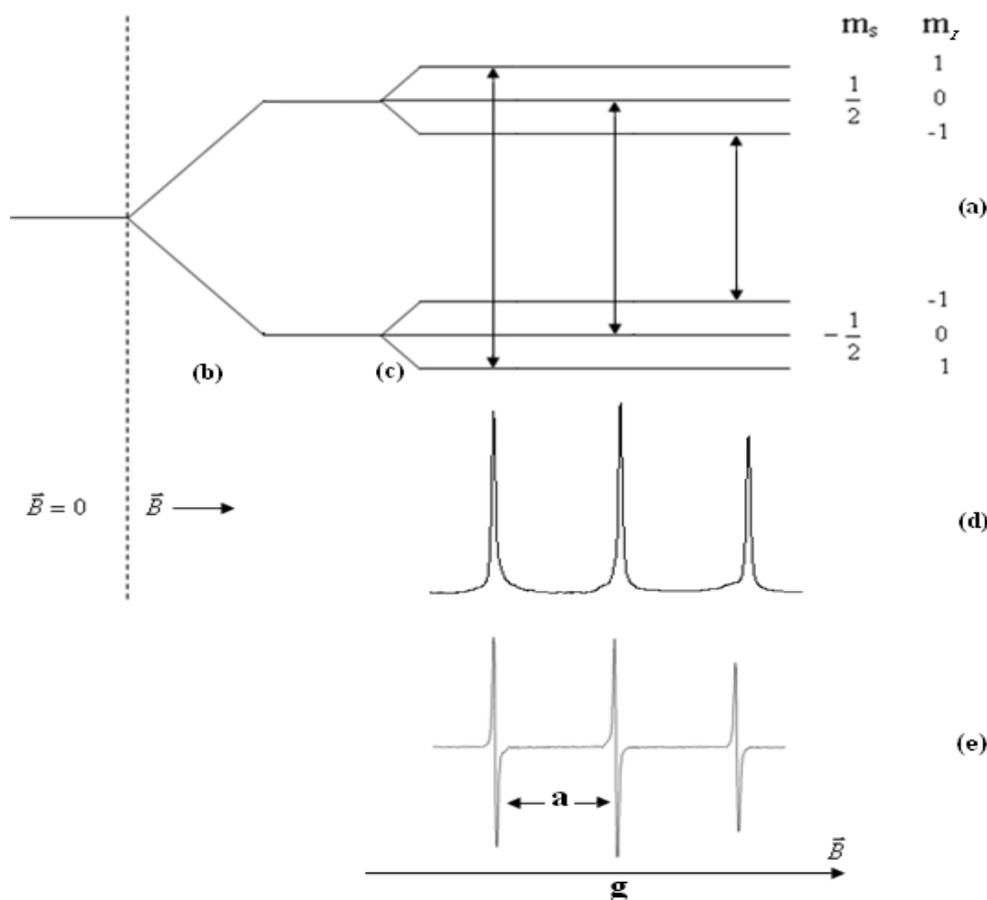
Figura 2.5: (a) Níveis de energia do elétron desemparelhado do grupo nitróxido (N-O) num campo magnético: (b) sem interação e (c) com interação com o spin do N (estrutura hiperfina). (d) espectro de adsorção e (e) primeira derivada do espectro de absorção;  $\mathbf{a}$  é a constante de desdobramento hiperfino, a posição da linha central é definida pelo fator  $g$  [53].
