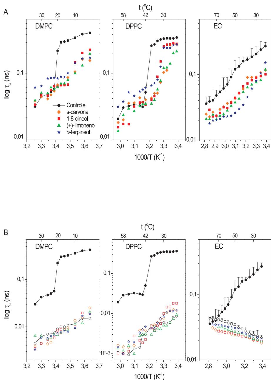
Figura 4.6: Tempo de correlação rotacional,  $\tau_c$ , do DTBN em membranas de DMPC, DPPC e estrato córneo (EC) versus o recíproco da temperatura absoluta. Os terpenos foram adicionados a uma fração molar terpeno:lipídio 0,75:1 para DMPC e DPPC, e 1% (peso/volume) utilizado nas amostras de EC. Os painéis A e B se referem ao marcador na membrana e no solvente, respectivamente
