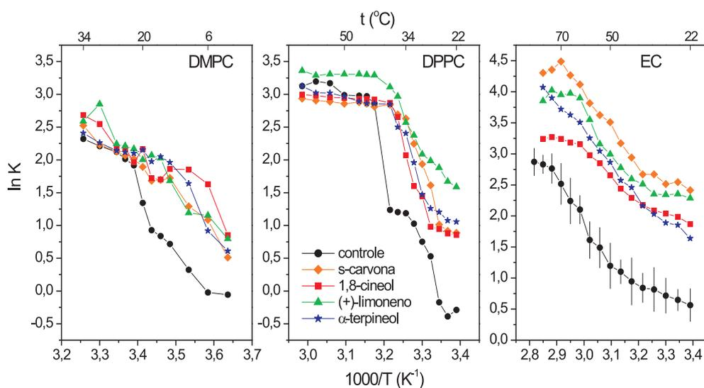
Figura 4.4: Logaritmo natural do coeficiente de partição,  $\ln K$ , do DTBN em vesículas multilamelares de DMPC, DPPC e membranas de estrato córneo (EC) versus a temperatura absoluta recíproca. Os terpenos foram acrescentados a uma razão molar de terpenos:lipídios de 0,75:1 para DMPC e DPPC e a 1% terpeno (peso/volume) em estrato córneo.
