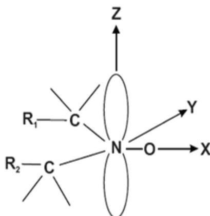
Figura 2.7: Esquema do radical nitróxido, mostrando as orientações dos eixos principais dos tensores de segunda ordem  $\bar{g}$  e  $\bar{a}$ . Os grupos  $R_1$  e  $R_2$  permitem a reação do radical sem envolver o elemento para-magnético  $N - O$ .
