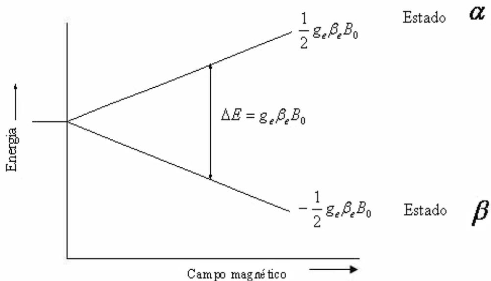
Figura 2.1: Separação entre os níveis de energia  $\alpha$  e  $\beta$ , provocado pela ação de um campo magnético externo.
