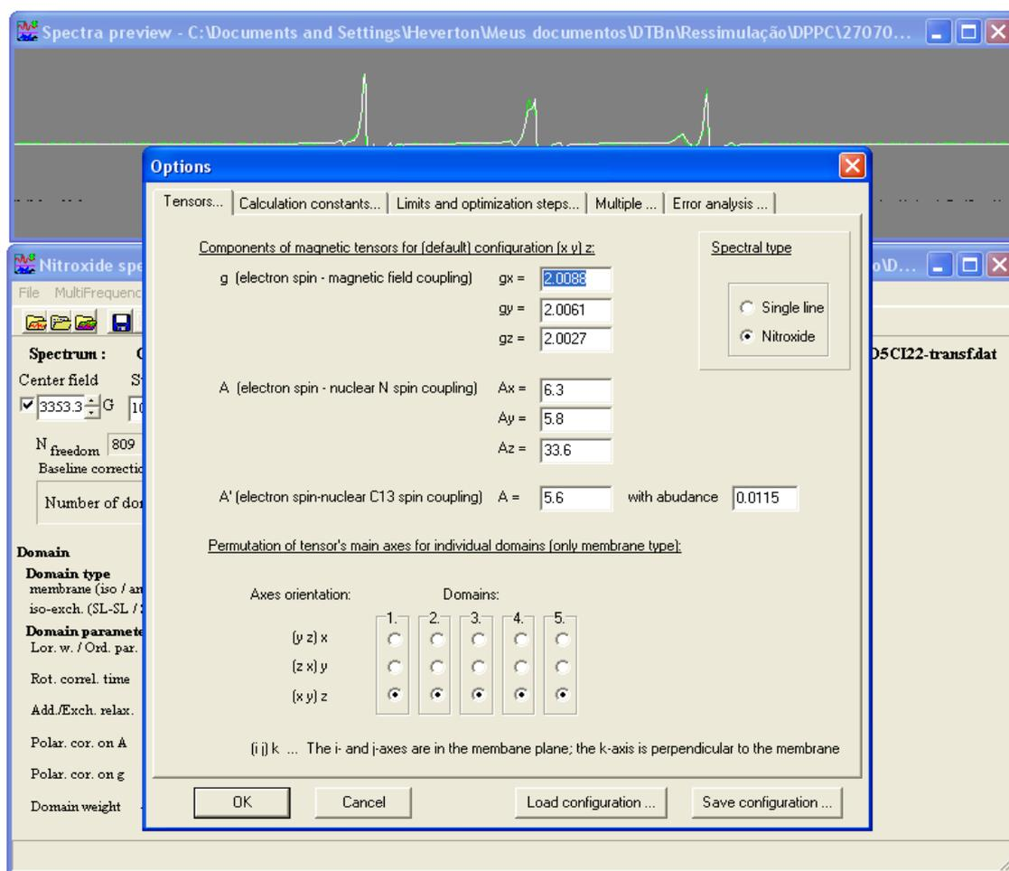
Figura 2.10: Janela do programa EPRSIM, versão 4.99, onde é permitido introduzir os valores dos tensores magnéticos  $A$  e  $g$ , a magnitude e abundância da interação do spin nuclear C-13 e também definir o eixo de simulação da membrana.
