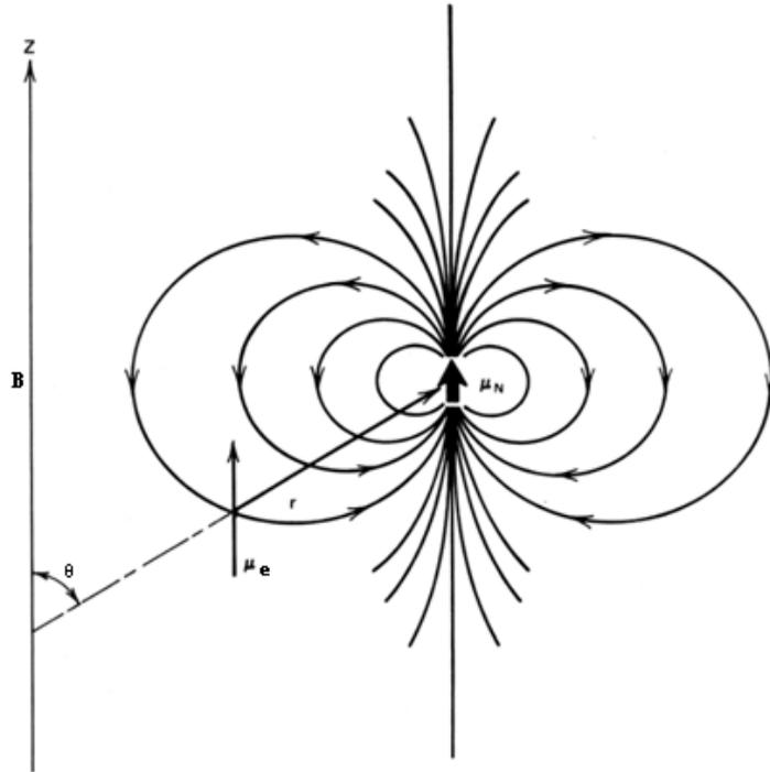
Figura 2.3: Interação dos momentos de dipolos do elétron ( $\hat{\mu}_e$ ) e do núcleo ( $\hat{\mu}_n$ ). O vetor  $\hat{\mu}_e$  é indicado pelo estado  $\hat{m}_S = -\frac{1}{2}$  e o vetor  $\hat{\mu}_n$  é indicado pelo estado  $\hat{I} = +\frac{1}{2}$ . O ângulo  $\theta$  é formado entre o vetor  $\vec{r}$ , que liga os dipolos, e o campo aplicado  $\vec{B}$ .
