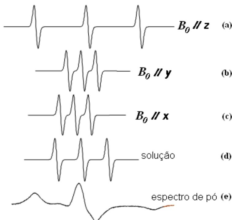
Figura 2.8: Espectro de RPE retratando a anisotropia do fator  $g$  e da constante de acoplamento hiperfino. (a) Campo magnético aplicado paralelo ao eixo  $z$ , (b) na direção do eixo  $y$  e (c) quando o campo está ao longo do eixo  $x$ . (d) Espectro do marcador em solução e (f) espectro obtido a  $-70$  °C (espectro de pó).
