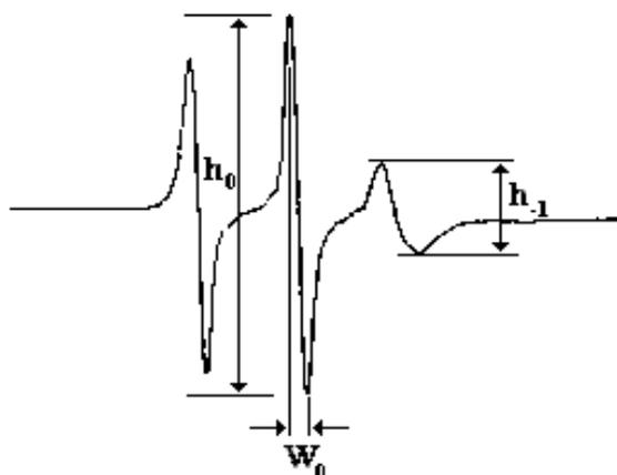
Figura 2.9: Espectro de RPE do marcador de spin 16-SASL em membranas musculares a 37° C com varredura de 100 G, indicando a medida dos parâmetros  $h_0$ ,  $W_0$  e  $h_{-1}$ .
