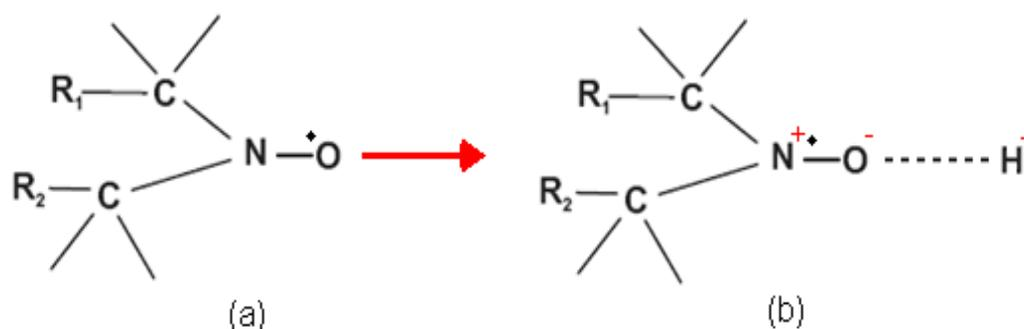
Figura 2.6: Figura esquemática mostrando o oxigênio do radical nitroxido realizando ligação de hidrogênio, onde o hidrogênio polariza a ligação N - O fazendo que o elétron se localize mais próximo do núcleo do átomo de nitrogênio aumentando assim a contribuição do acoplamento hiperfino isotrópico.
