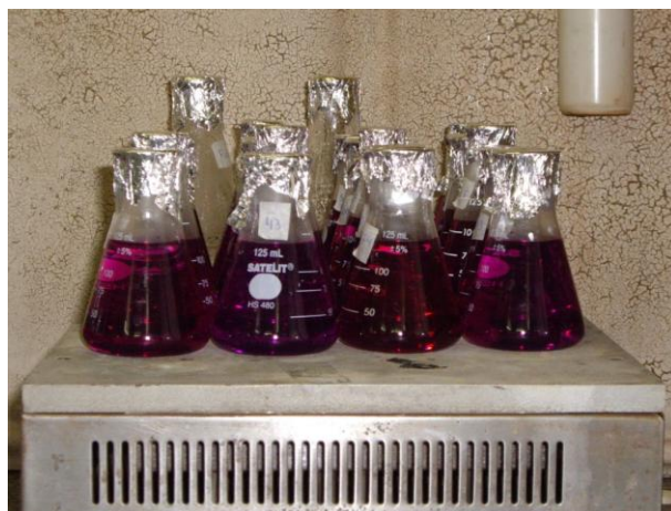
Figura 21: Análise de demanda química de oxigênio (DQO) na chapa quente.
