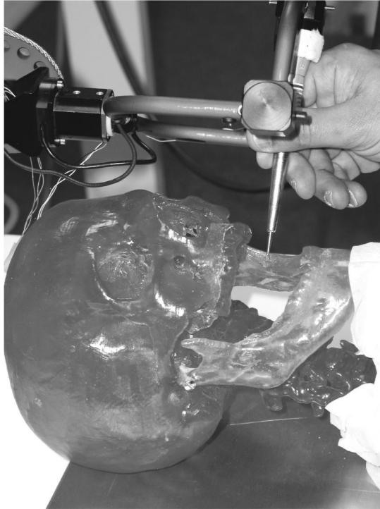
Figura 4 – Cobot cirurgião evita a ocorrência de danos nos nervos [14]
