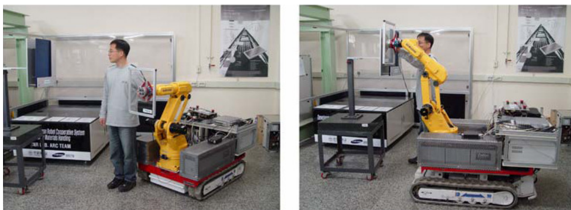
Figura 9 – Robô desenvolvido para auxiliar na construção civil: a posição da peça é coordenada pelo operador [22].
