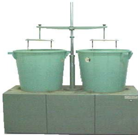
FIGURA 6. Aparelho de Yoder, utilizado para a determinação da estabilidade dos agregados por via úmida. Fonte: Silva, 2008
