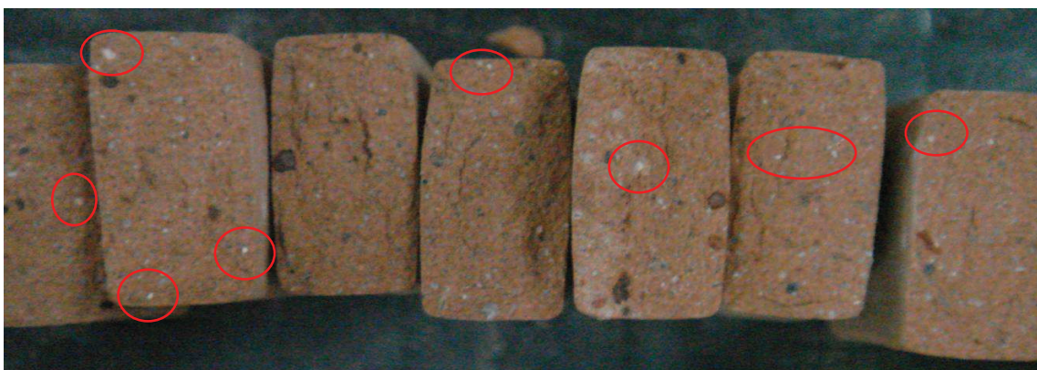
Figura 4.23 – Partículas de aço no interior dos corpos de prova.
