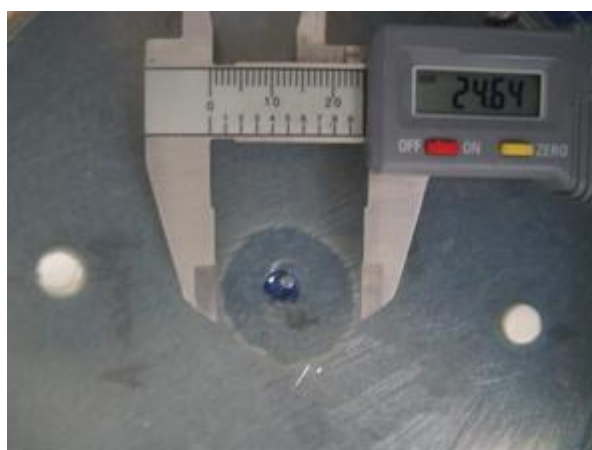
Figura 13 - Foto demonstrando como foram mensurados nas placas, os halos de inibição com um paquímetro digital
