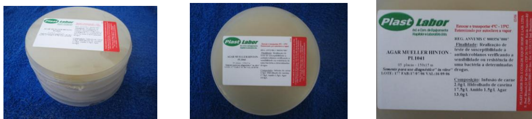
Figura 7 - Placas de Petri contendo o meio de cultura Agar Mueller-Hinton
