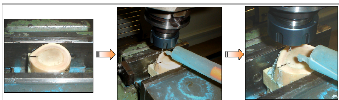
Figura 3.6: Preparação dos alojamentos para os termopares.
