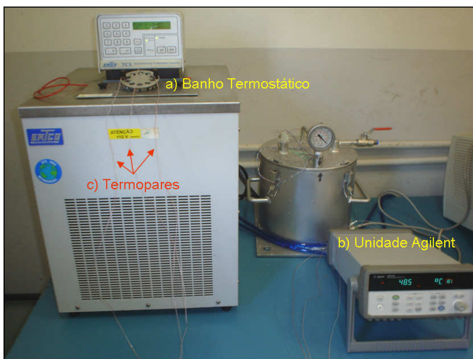
Figura 3.1: Aparato do ensaio de calibração. a) Banho termostático ERTCO ® , b) Unidade de aquisição Agilent e c) Termopares.
