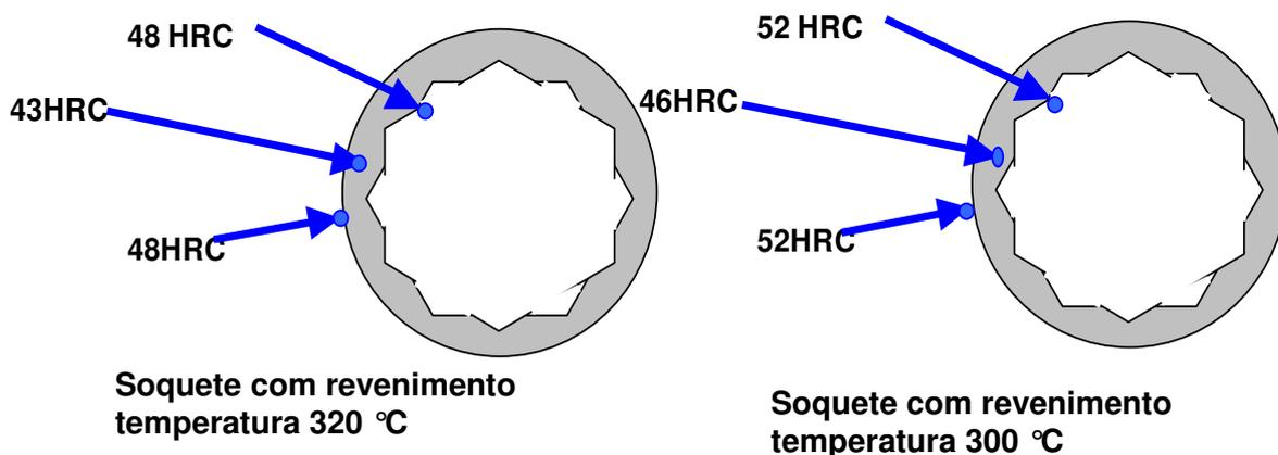
Figura 33 - Mapeamento de dureza do soquete com os devidos revenimentos.
