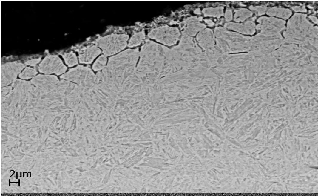
Figura 26 – Micrografia da borda externa do soquete temperado, sem revenimento.
