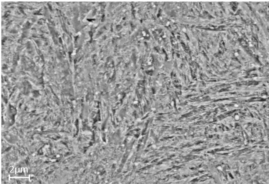
Figura 30 - Micrografia do interior do soquete, temperado e revenido.
