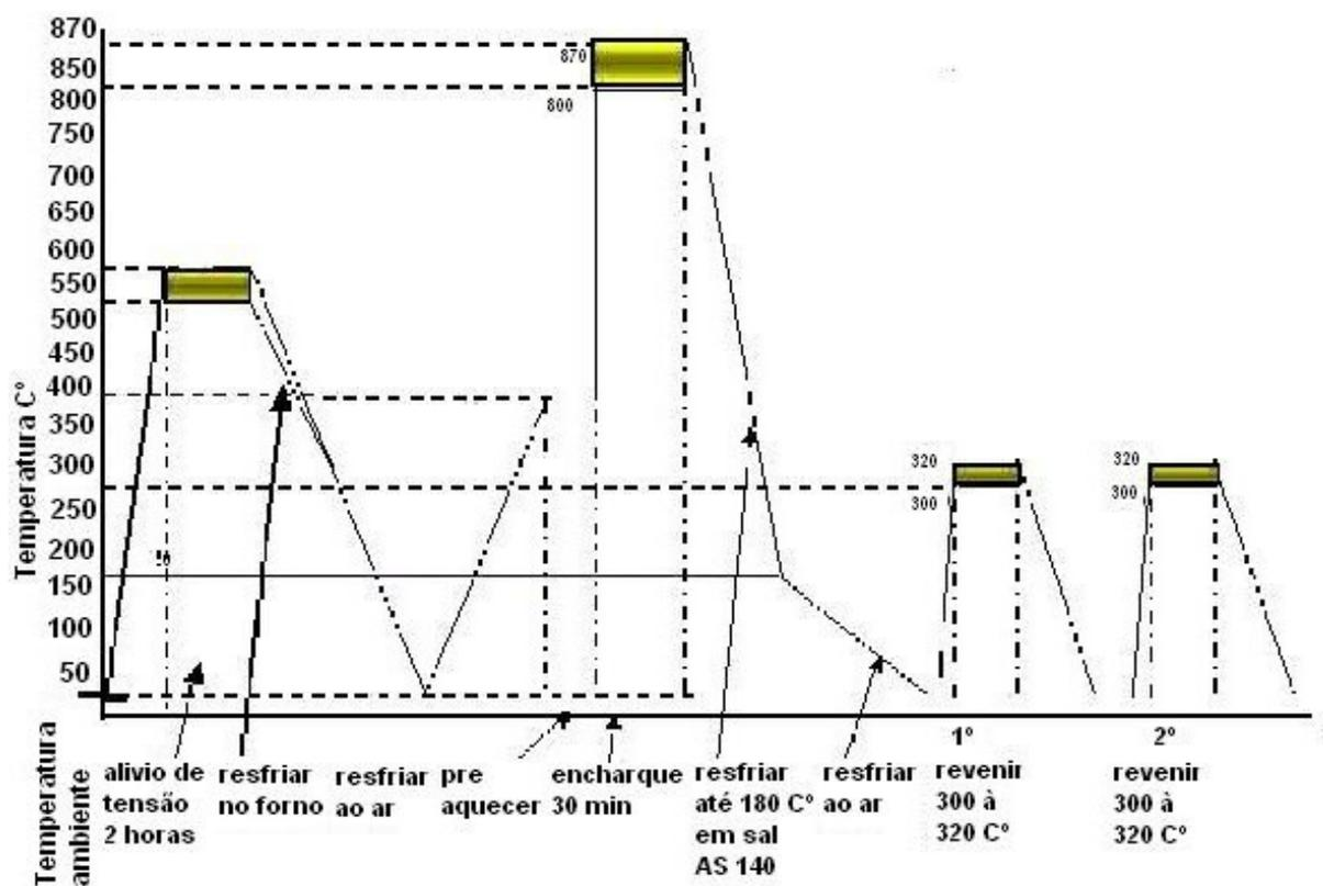
Figura 9 – Gráfico do processo de desenvolvimento do tratamento térmico
